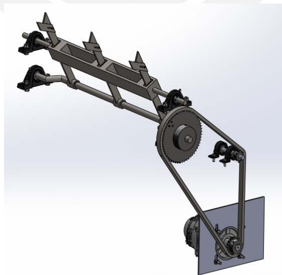
Figura 3.12.: Diseño Definitivo Sistema Alimentador
