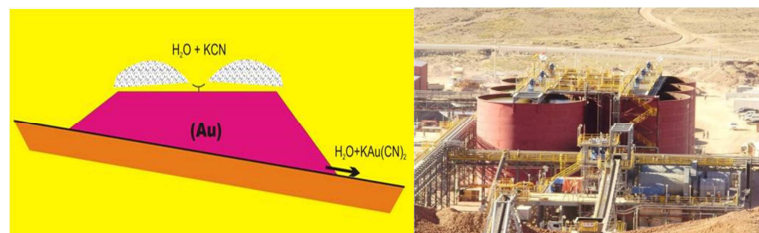
Figura I.1. a) Esquema de lixiviación en pilas, b) Lixiviación en tanques agitadores
