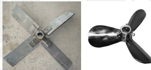
Figura 1.4 Impulsor de paletas inclinadas (izq.) y hélice (der.)
