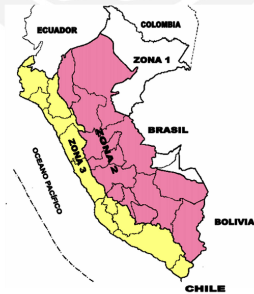
Figura 1.6 Zonas sísmicas en el Perú [MVCS, 2006]
