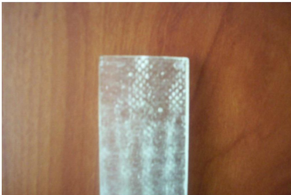
Figura B3: Presencia de pequeñas burbujas
