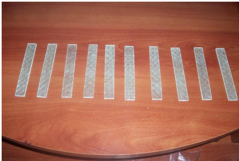
Figura A27: Especímenes fabricados para flexión de [0/90/45/-45] s
