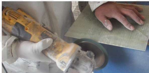
Figura A18: Corte del Laminado con sierra de disco DEWALT
