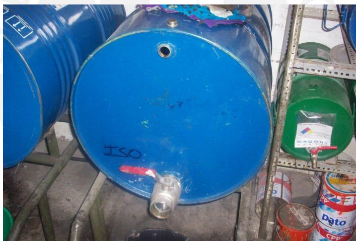
Figura A6: Tanque de almacenamiento de resina de poliéster isoftálica
