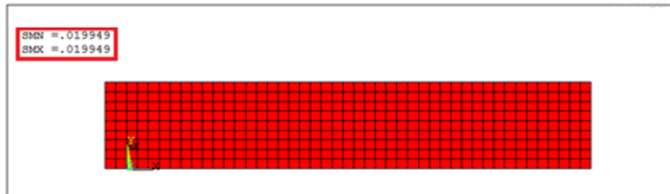
Figura E3: Deformación en el eje principal ( \epsilon_1 ) – Láminas [0/90]
