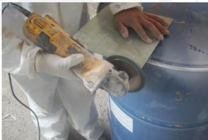
Figura A20: Lijado del espécimen
