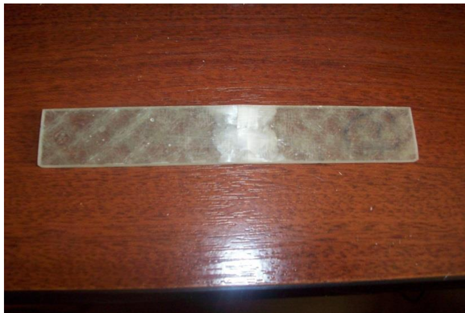
Figura B25: Fractura – Ensayo de flexión
