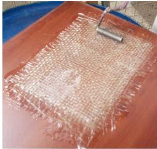
Figura A11: Eliminación de exceso de resina y aire mediante rodillo metálico (1/2 x 3/4 pulg.)
