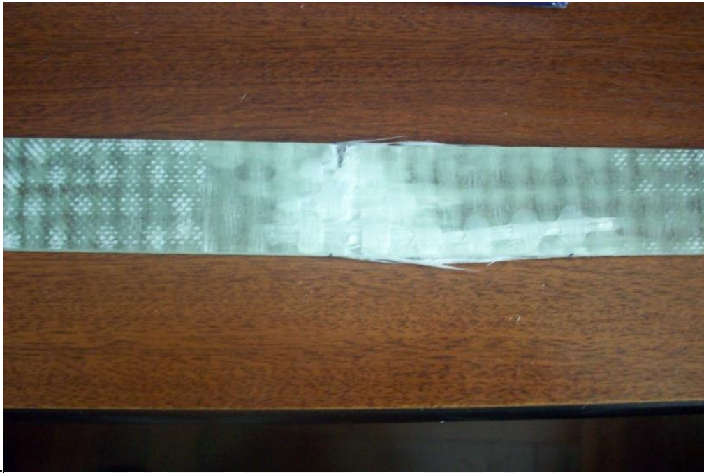
Figura B13: Fractura – Ensayo #1
