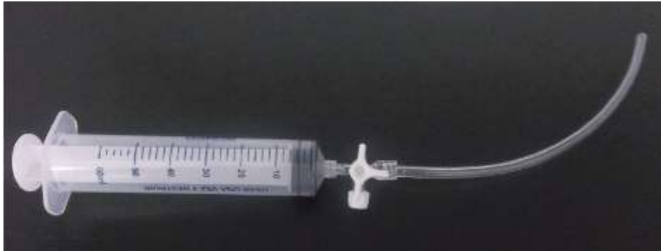
Figura N° 25: Jeringa de 50 ml acoplada a una llave de tres vías y una manguera de 40 cm
