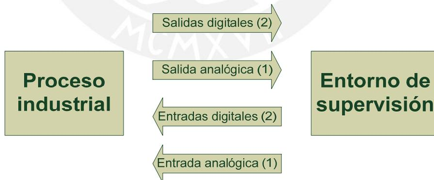
Figura 3. 12. Señales necesarias para el control de velocidad del motor
