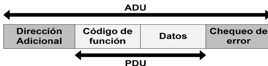
Figura 2. 4. Mensaje MODBUS
