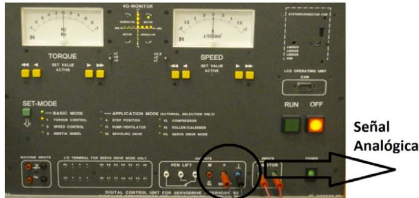
Figura 3. 10. Salida analógica (Módulo de Control)
