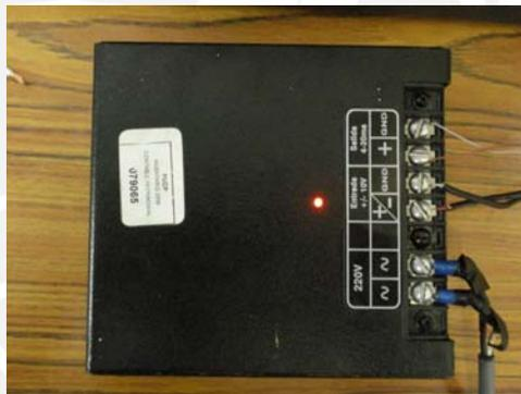
Figura 4. 2. Convertidor de voltaje a corriente
