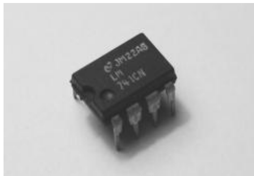
Figura 3.2. Amplificador Operacional LM741. [36]
