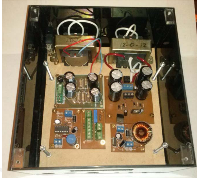
Figura 3.21 Montaje de tarjetas en el primer nivel del chasis
