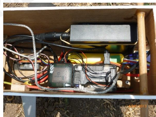
d) Disposición del ardupilot y el fit-PC2 en el aeroplano
