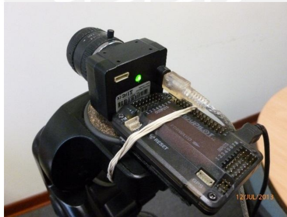
b) Cámara y Ardupilot colocadas en el trípode
