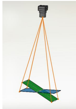
Figura 3.14 Proyección de las aristas de la imagen rotada (plano verde con dimensiones de 640x480)
