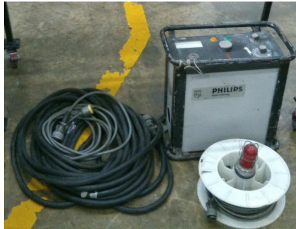
Foto No.2.1.: Unidad de control de un equipo de rayos X
