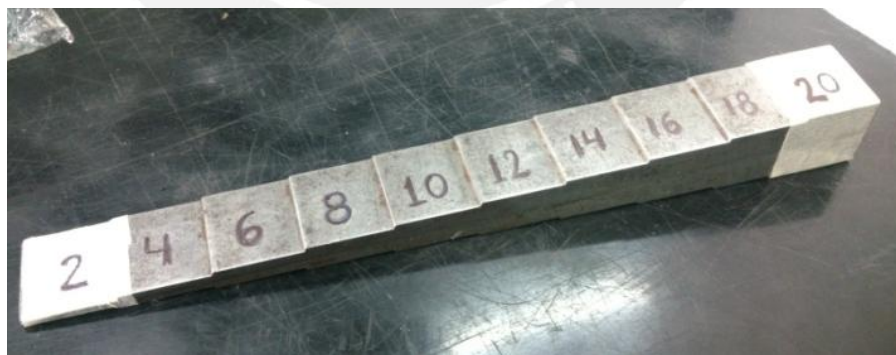
Foto No.3.1.: Patrón escalonado de acero, objeto de prueba (números en mm)
