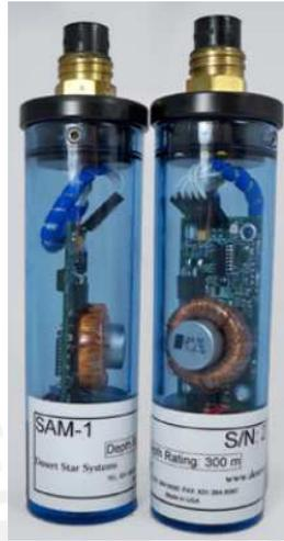
Figura 3.2.7: Vista isométrica del módem acústico
