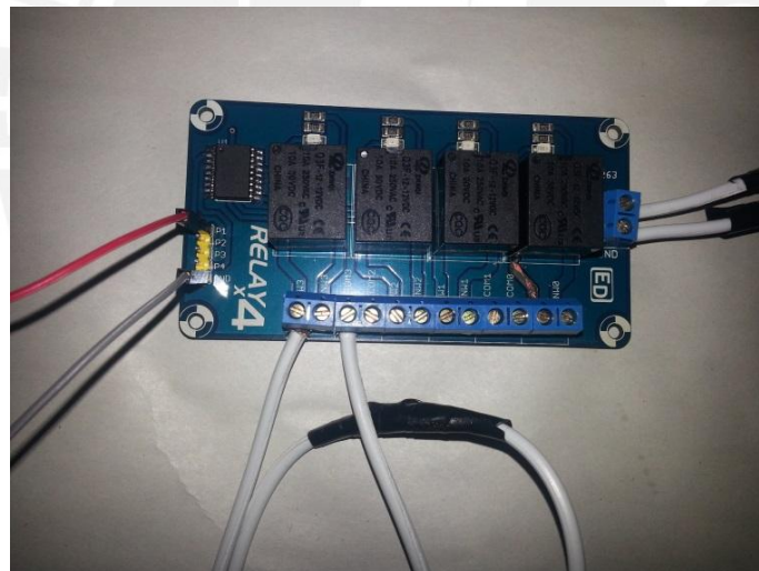
Figura 4.18 Conexiones necesarias para controlar un circuito con un relé y el micro controlador Elaboración propia
