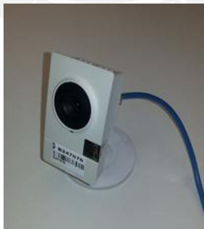
Figura 4.28 Cámara Dcs-2130 conectada mediante un cable Ethernet Elaboración propia
