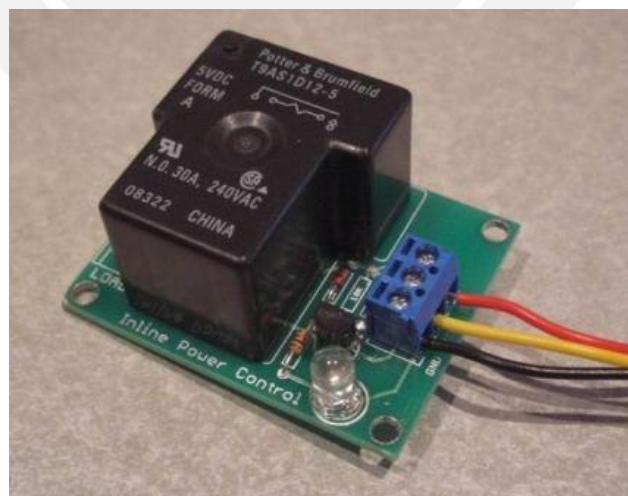
Figura 2.7 Ejemplo de un relé para controlar un circuito eléctrico. Fuente: [1]
