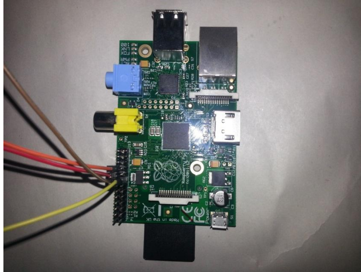
Figura 4.19 Conexiones en el raspberry pi para la comunicación con la tarjeta de relés Fuente: Elaboración propia
