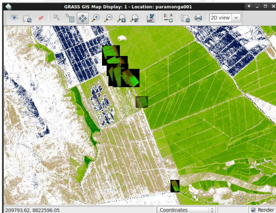
Figura 4.13: Superposición de varios registros ortorectificados y georeferenciados sobre una Imagen Satelital
