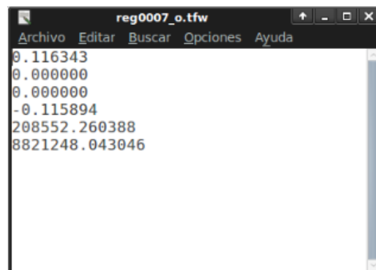
Figura 3.9: Archivo TFW de una imagen Geotiff
