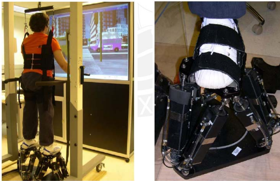
(a) (b) Figura 1.12: (a). Aplicación del Simulador de marcha con una interfase en realidad virtual [BOIAN, 2004] (b) Vista del prototipo, [BOIAN, 2004]
