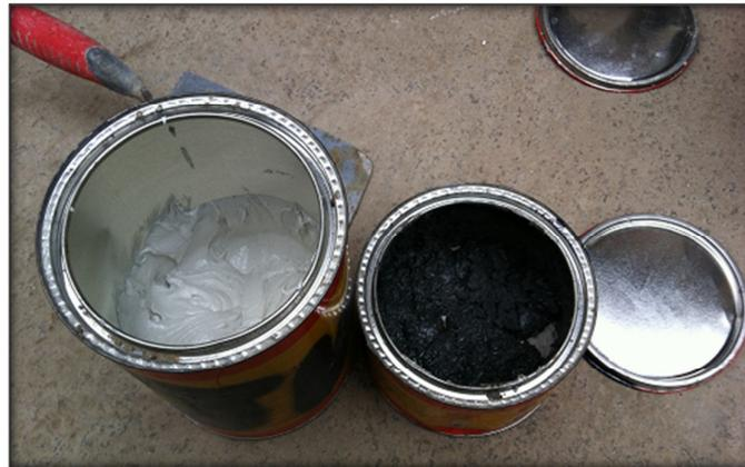
Fig.3.3 Componente A y B del Sikadur 31
