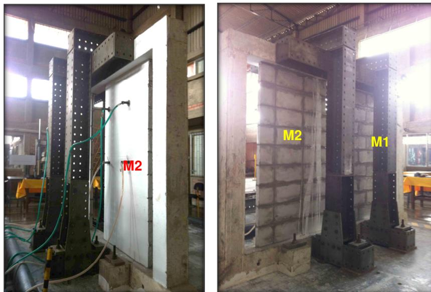
Fig.5.2. Arriostramiento de la viga del pórtico.
