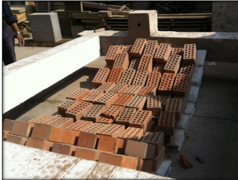
Fig.7.4 Colapso del Muro M1
