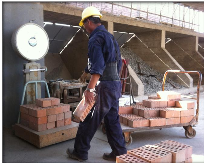
Fig.7.5 Pesaje de los ladrillos en balanza
