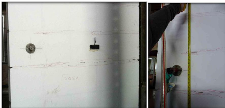
Fig.5.5. Fisuras horizontales en 2 juntas centrales de M1.
