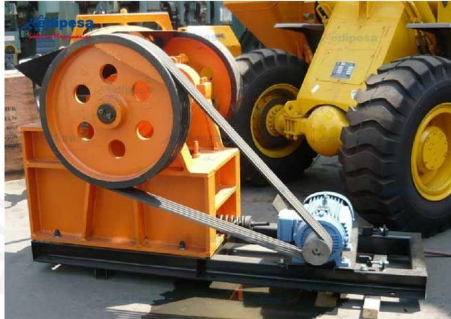
Figura 2.3: Accionamiento y Transmisión de la Trituradora de Mandíbula
