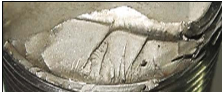
Gráfico N° 3.14 - Zona de Ruptura por Sobrecarga (PERNO 2)
