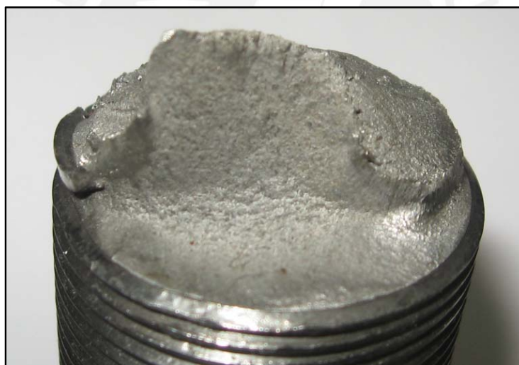
Gráfico N° 3.20 – Cambio de Dirección de Fractura (Perno 3)
