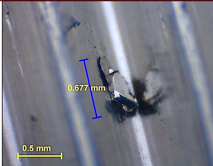
Gráfico N° 3.9 - Desprendimiento de Material en una Cara del Hilo (Perno 2)
