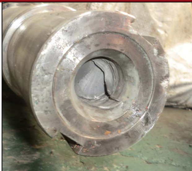
Gráfico N° 3.5 – Segmento de Perno Roscado en Eje 11
