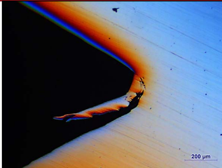
Gráfico N° 3.24 - Grieta en el Hilo (Perno 2)
