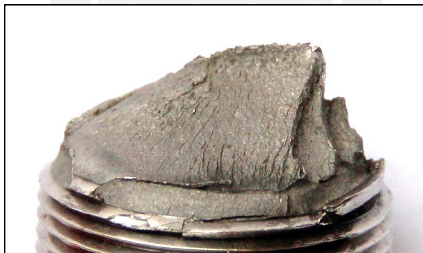
Gráfico N° 3.18 – Borde Inicio de Fractura (Perno 3)
