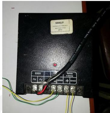
Fig. 3.27: Conversor de voltaje a corriente
