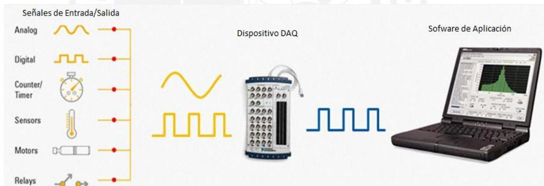
Fig. 3.2: Partes de un sistema DAQ [14]
