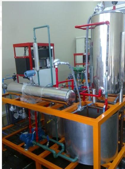
Fig. 1.1: Planta intercambiador de calor ubicada en el laboratorio Automatización.
