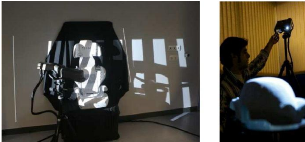
Figura 115: Escaneado 3D mediante luz blanca estructurada. <17>
