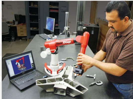
Figura 111: Ejemplo de escaneo por medio de punta exploratoria montada sobre un brazo robot ( Joint Arms ). <13>
