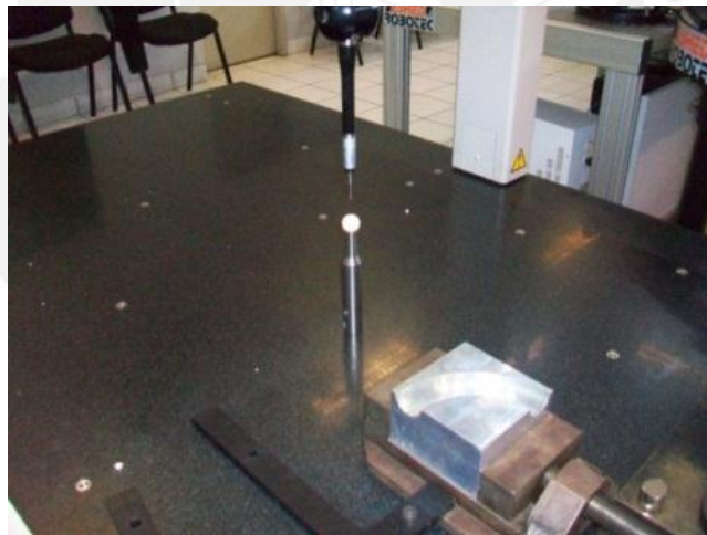
Figura 77: Calibración de la Máquina de Medición por Coordenadas.
