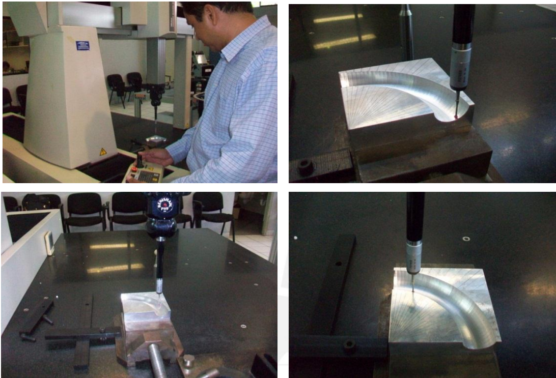
Figura 89: Digitalización del modelo maquinado 1 en la Máquina de Medición por Coordenadas.
