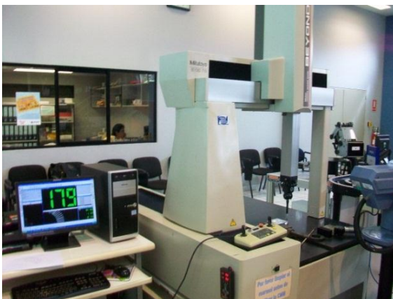
Figura 2: Digitalización en Máquina de Medición por Coordenadas.
