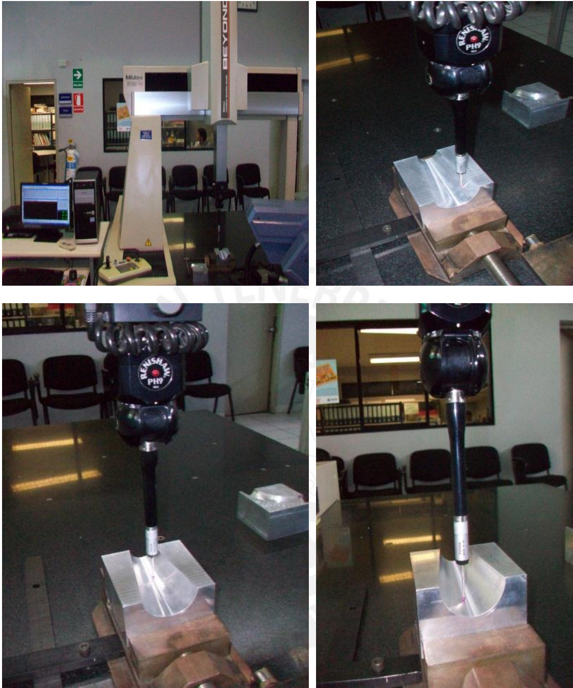
Figura 101: Digitalización del modelo maquinado 2 en la Máquina de Medición por Coordenadas.
