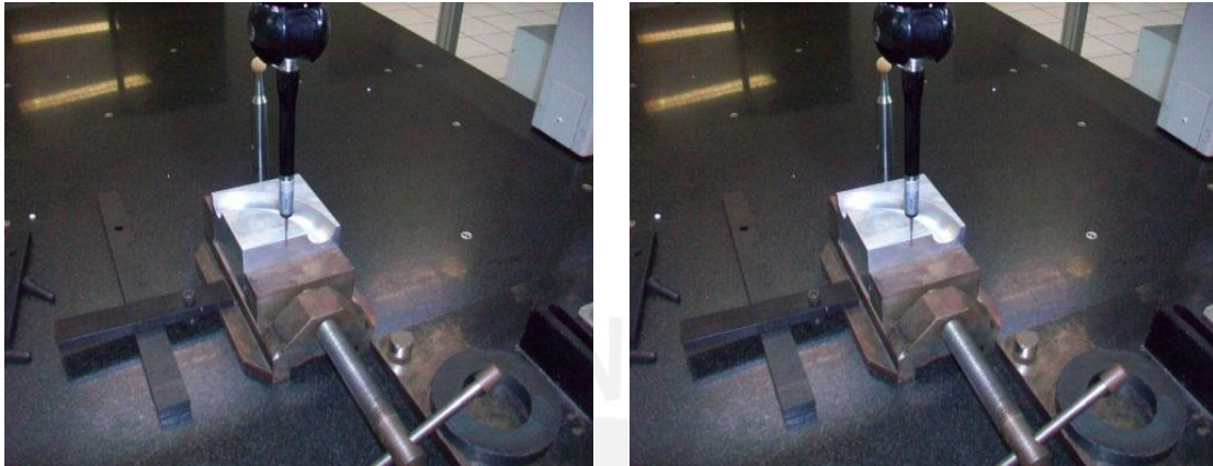
Figura 78: Preparación de los planos de referencia en la pieza mecánica.
