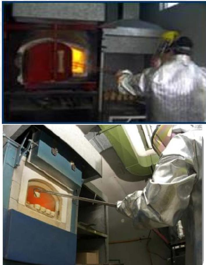
Figura 9 Procesos de fundición y copelación
