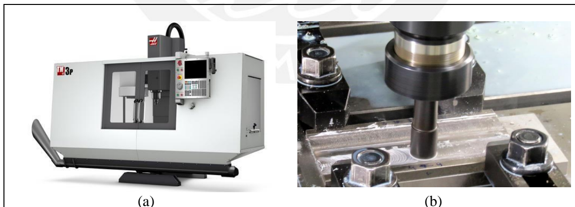
Figura 4. Máquina CNC HAAS TM3P y operaciones de FSP.
