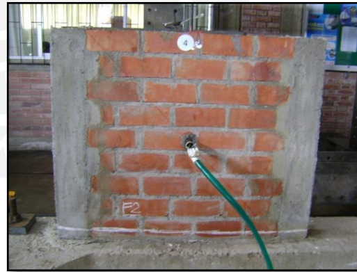
Figura 6.5. M4-Fase2 (grieta en la base)
