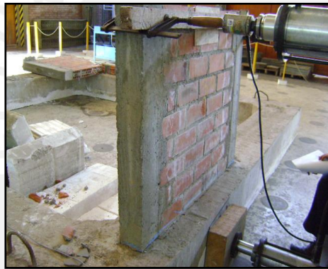
Figura 7.2. Ensayo estático de parapeto M1
