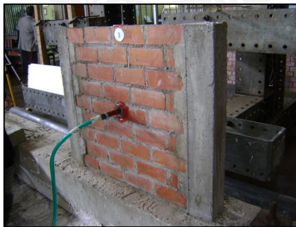
Figura 6.1. Acelerómetro en el centro de masa del parapeto M3.
