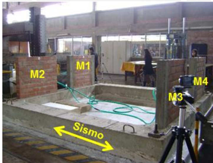
Figura 6.3. Dirección del movimiento sísmico, perpendicular al plano de los parapetos.
