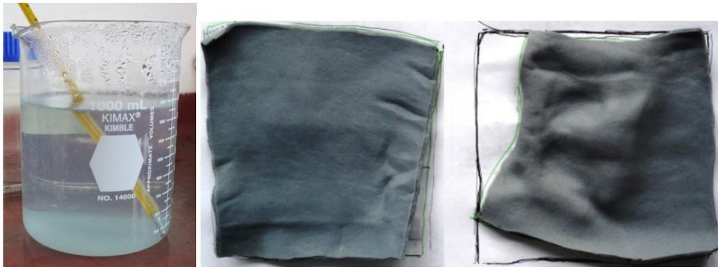
**Figura 24** – Agua donde se realizó la prueba de encogimiento, (izquierda) y cuero antes y después de la prueba de encogimiento (derecha).
