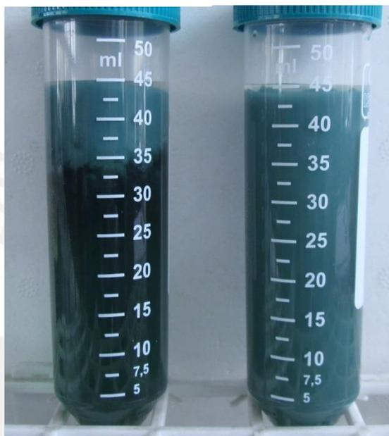
**Figura 39** – Efecto de la adición de  $\text{H}_2\text{SO}_4$  10M a precipitados de  $\text{Cr}(\text{OH})_3$  que fueron previamente calentados a diferentes temperaturas
