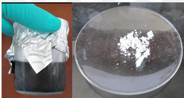
**Figura 13** – Solución de  $\text{Cr}_2(\text{SO}_4)_3$  obtenida, con el precipitado blanco en el fondo (izquierda). Precipitado blanco lavado y seco (derecha).
