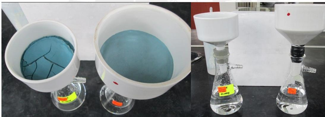
**Figura 9** –  $\text{Cr}(\text{OH})_3$  filtrado (izquierda) y aguas madres obtenidas después de filtrar (derecha).
