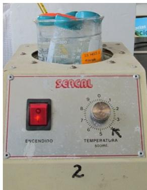
**Figura 18** – Baño de agua en donde se calentaron los tubos de centrifuga para estudiar el efecto de la temperatura sobre la velocidad de compactación del  $\text{Cr}(\text{OH})_3$
