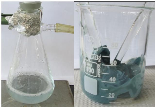
**Figura 12** – Aguas madres verdosas obtenidas después de la primera filtración (izquierda) y  $\text{Cr}(\text{OH})_3$  húmedo (derecha).
