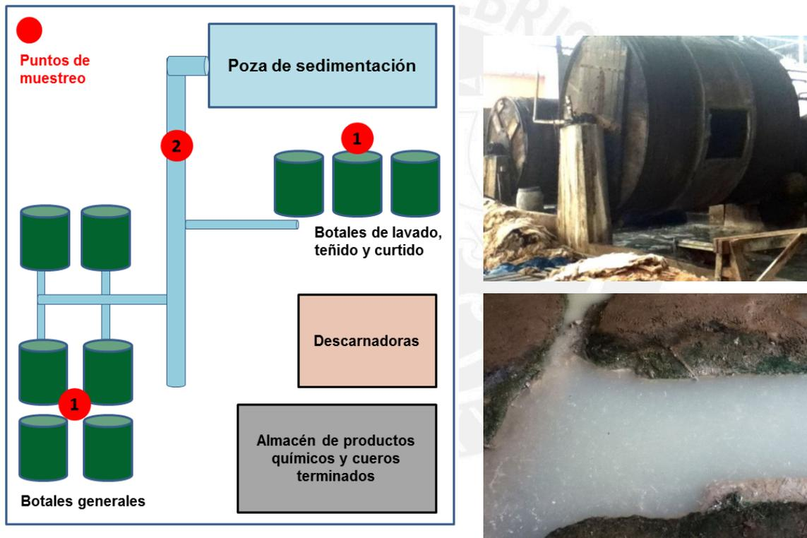
**Figura 6** – Distribución de los botalos y las cañerías en la fábrica (izquierda). Botalo rotatorio de donde se toman las muestras de baños de curtido (derecha arriba). Cañería que recoge los efluentes generales de la fábrica y los lleva a la poza de sedimentación (derecha abajo)
