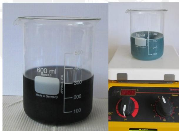
**Figura 11** – Aspecto del baño de curtido utilizado en la recuperación de cromo (izquierda) y del precipitado de  $\text{Cr}(\text{OH})_3$  obtenido (derecha)
