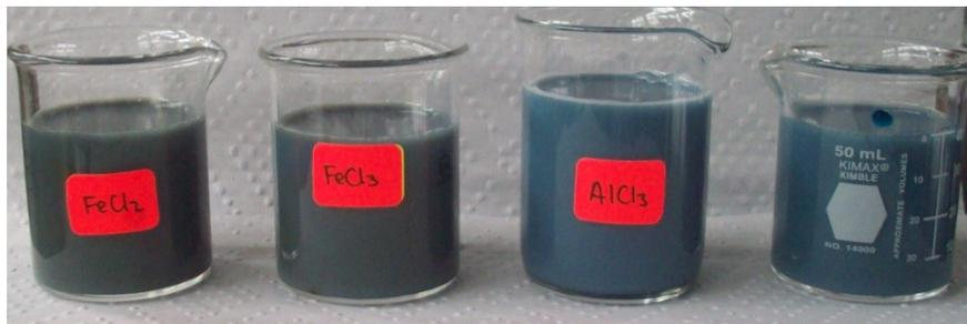
**Figura 19** – Suspensión coloidal recién agitada de  $\text{Cr}(\text{OH})_3$ , con diferentes coagulantes.
