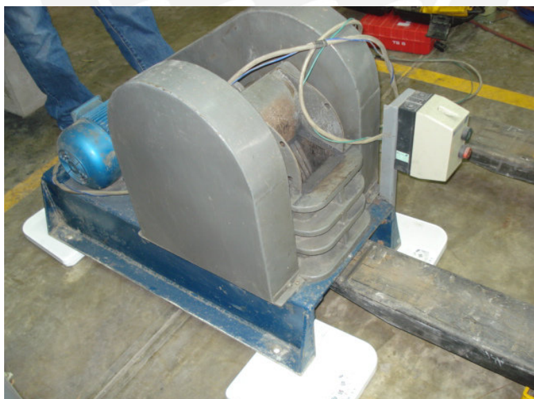
Fig. A2.2 Ubicación de la Chancadora de Quijada para Posteriormente Apoyarla sobre las Balanzas.
