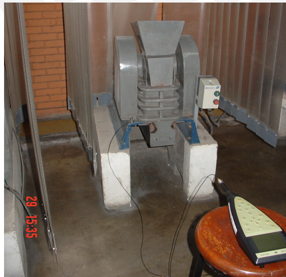
Fig. A1.2 Analizador de Señales FFT conectado a la Chancadora de Quijada.
