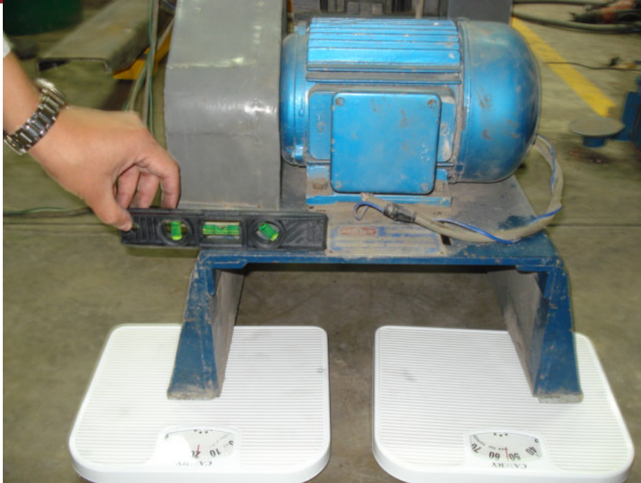
Fig. A2.3 Verificación del Nivel en la Chancadora de Quijada.
