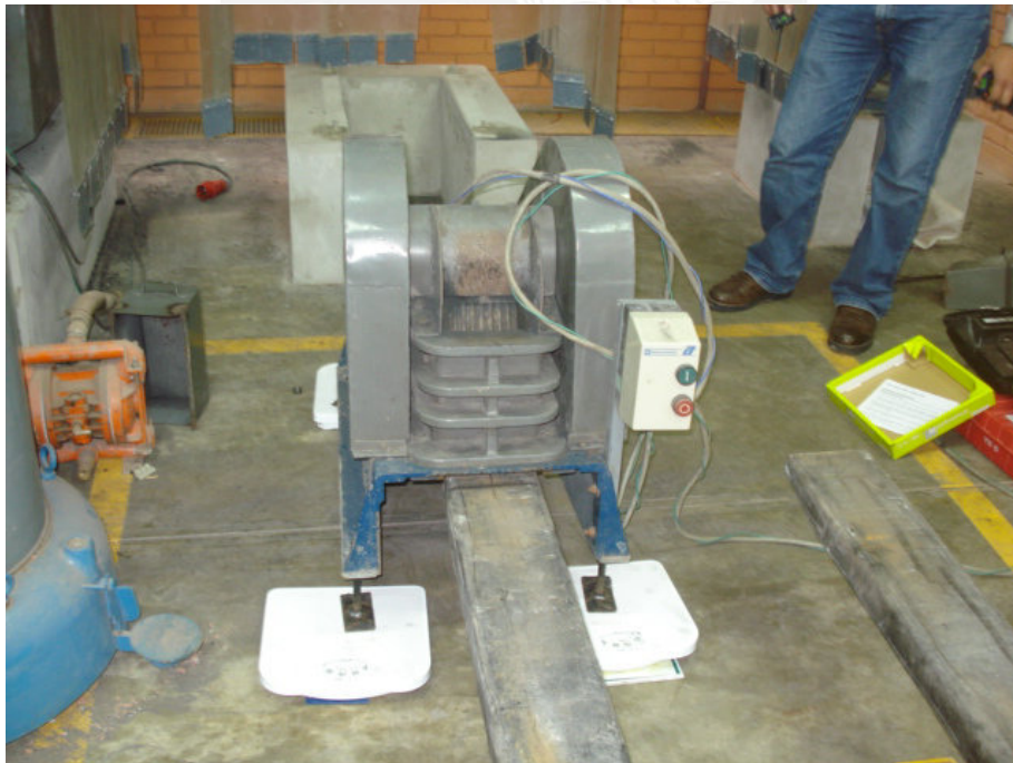
Fig. A2.4 Chancadora de Quijada Apoyada sobre las Balanzas.
