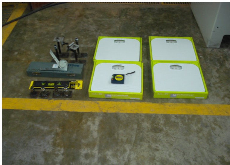
Fig. A2.1 Balanzas Utilizadas para Medir el Peso Generado en Cada Apoyo de la Chancadora de Quijada.
