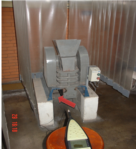
Figura 3.6 Toma de medidas de vibración en la Chancadora de Quijada.
