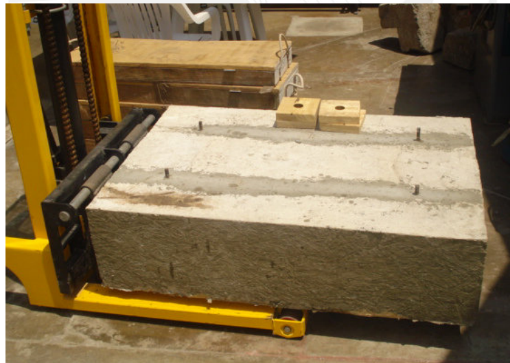
Figura 3.2 Bloque de cemento y fierro para la cimentación de la Chancadora de Quijada.
