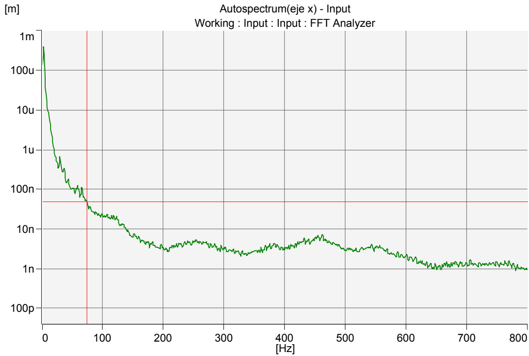
Figura 3.26 Espectro de Desplazamiento de la Chancadora de Quijada en el Eje X.
