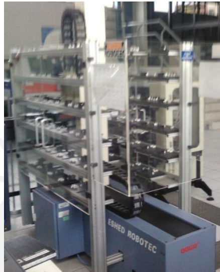
Figura 1.2. Estación de Almacén automatizado
