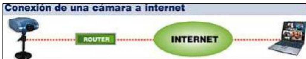
Figura 2.1. Elementos de sistema de video-monitoreo IP [8]
