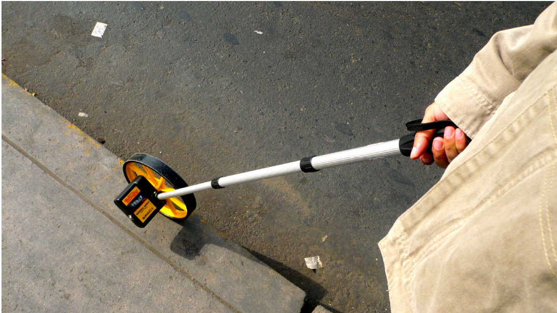
Fig. 6.1 Odómetro utilizado para hacer las mediciones de distancia. Fuente: propia
