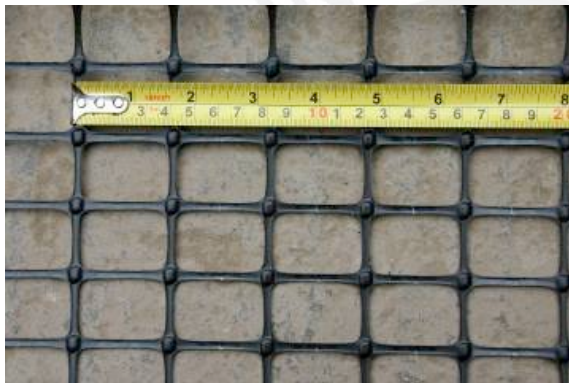
Figura 2.4. Dimensiones de las aberturas de la geomalla Tensar BX4100
