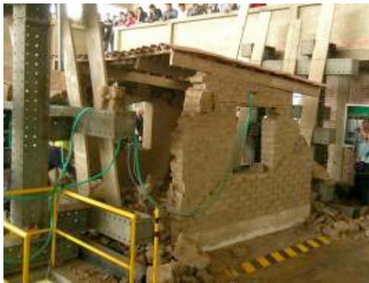
(a) Encuentro entre muro izquierdo y muro posterior
