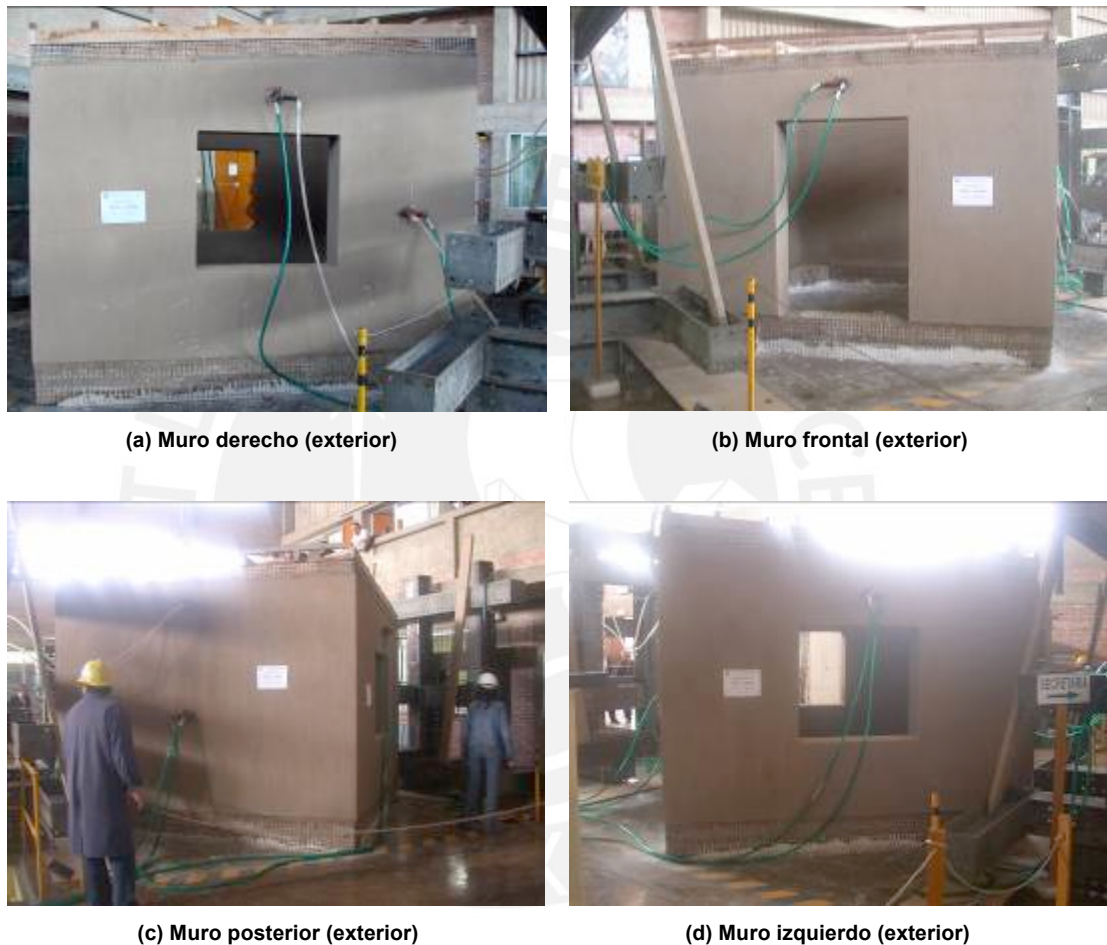
Figura 8.2 Daños en el módulo M100-T4100D – Post Fase 1 (30mm)
