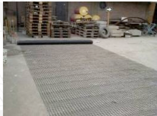
Figura 2.5. Rollo de geomalla Tensar BX4100
