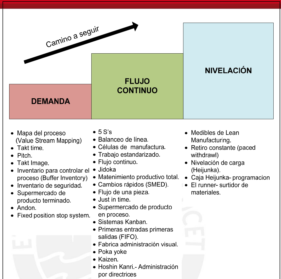
Figura 2 – Los tres niveles del Lean Manufacturing Fuente: Manual de Lean Manufacturing (2007)
