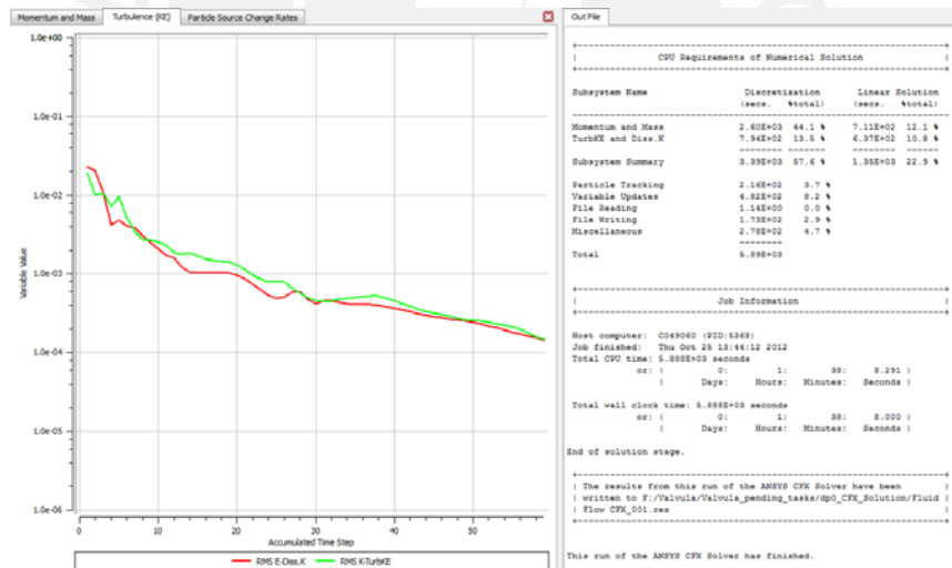
Figura R13. Interfaz del CFX-Solver mostrando el historial de convergencia de las velocidades del fluido [Material propio]
