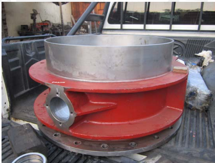
S2. Vista del cuerpo de la nueva válvula de admisión para su posterior mecanizado [Material propio]
