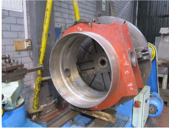
S3. Vista del cuerpo de la nueva válvula de admisión en el momento de su mecanizado [Material propio]
