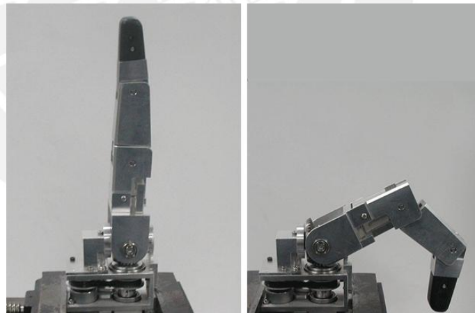
Figura 1.13 Mecanismo de dedo de mano, robot NAIST, [11].
