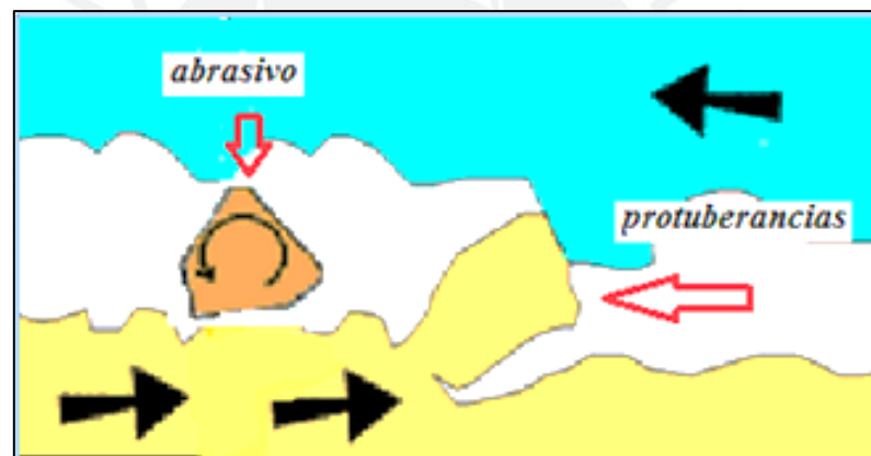
Figura 1-12. Efecto de las rugosidades en el desgaste [1]
