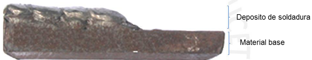
Figura 3-5 Muestras de material Base para metalografía
