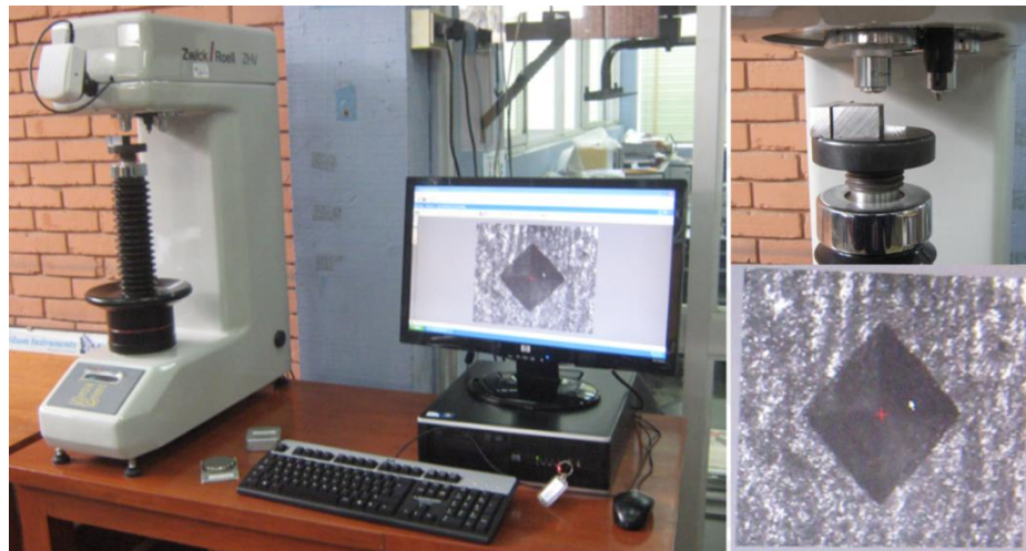
Figura 2-4 Durómetro Vickers y huella dejada por el indentador.
