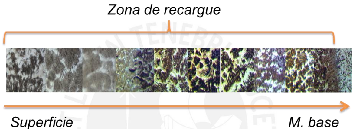
Figura 3-18 Barrido metalográfico de serie de cupones
