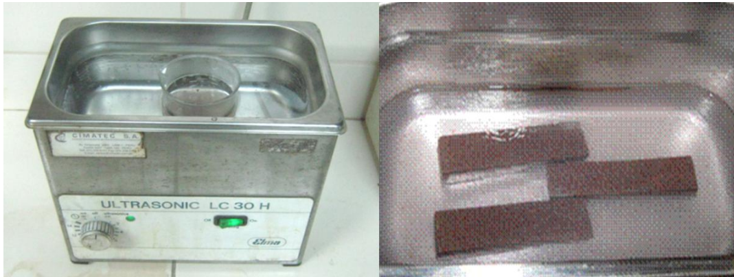
Figura 2-9. Cupones sometidos a una limpieza por ultrasonido en un baño de acetona
