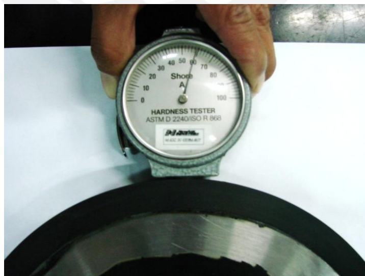
Figura 2-7 Toma de dureza Shore A del caucho de la rueda
