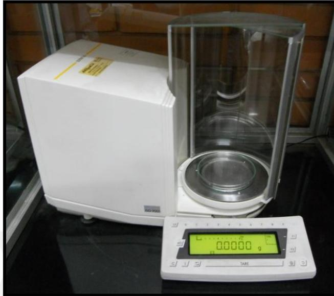
Figura 30. Balanza digital para el pesado de las probetas.
