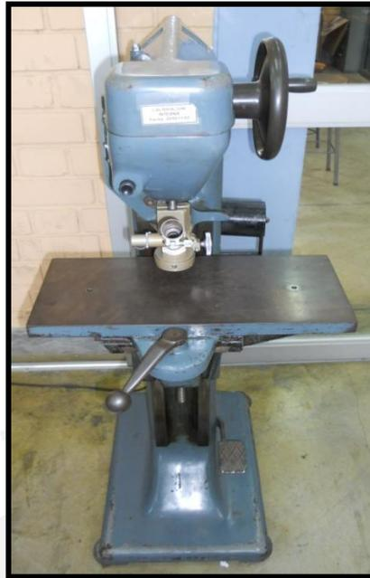
Figura 28. Durómetro Vickers para el ensayo de dureza.
