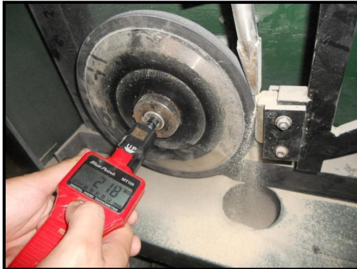
Figura 31. Medición de la velocidad de la rueda de caucho.
