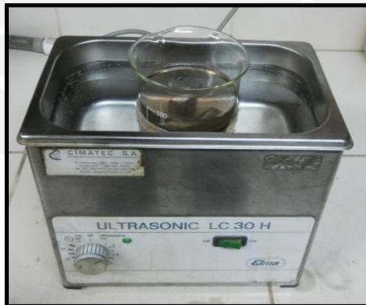
Figura 29. Limpieza de probetas con limpiado ultrasónico.
