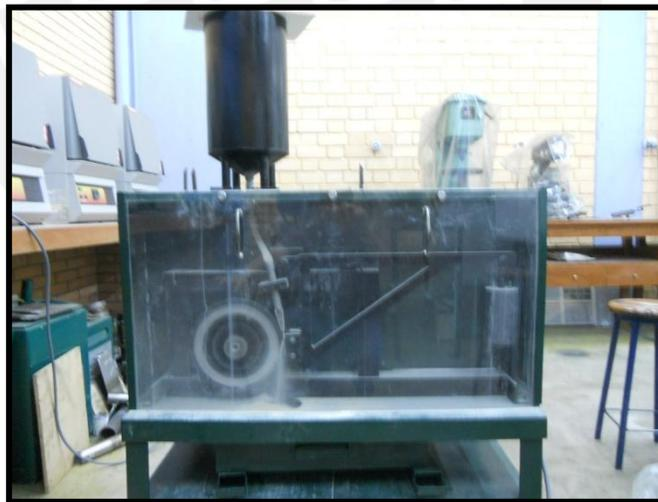
Figura 32. Hermetizado de la máquina de desgaste durante el ensayo.
