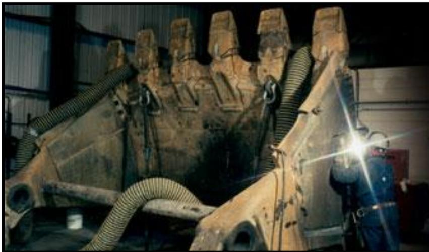
Figura 5. Aplicación de un recargue duro en el cucharón de un equipo minero [11].
