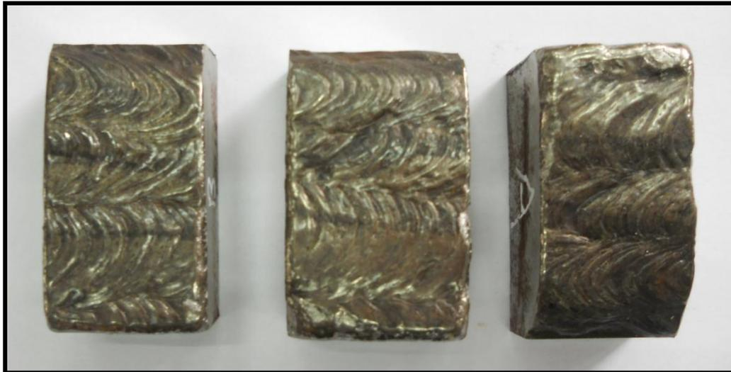
Figura 19. Probetas para ensayo de desgaste.
