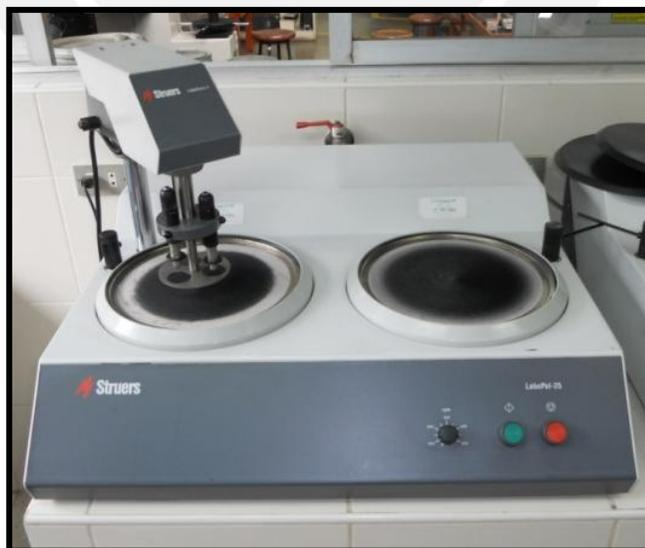
Figura 34. Pulidora mecánica marca Struers.
