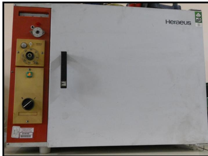
Figura 25. Horno para el secado de arena del Laboratorio de Fundición PUCP.
