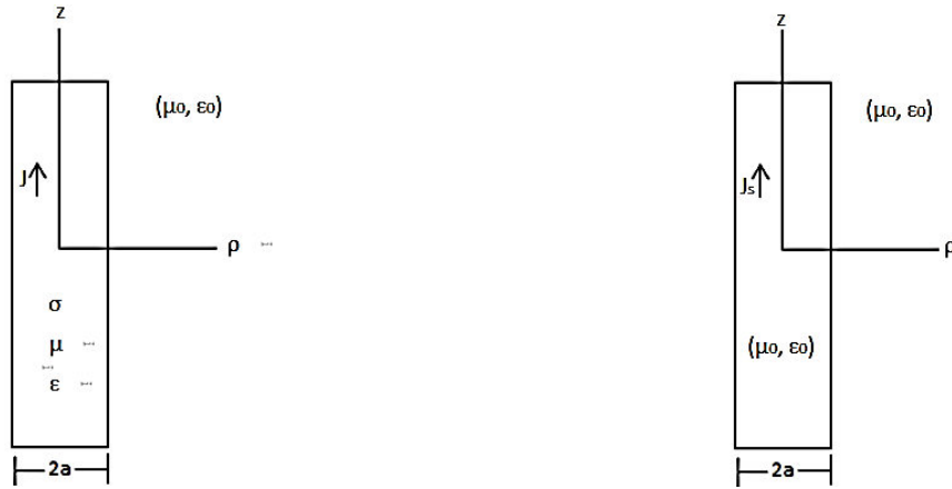
(a) Alambre de alta conductividad con densidad de corriente J .
