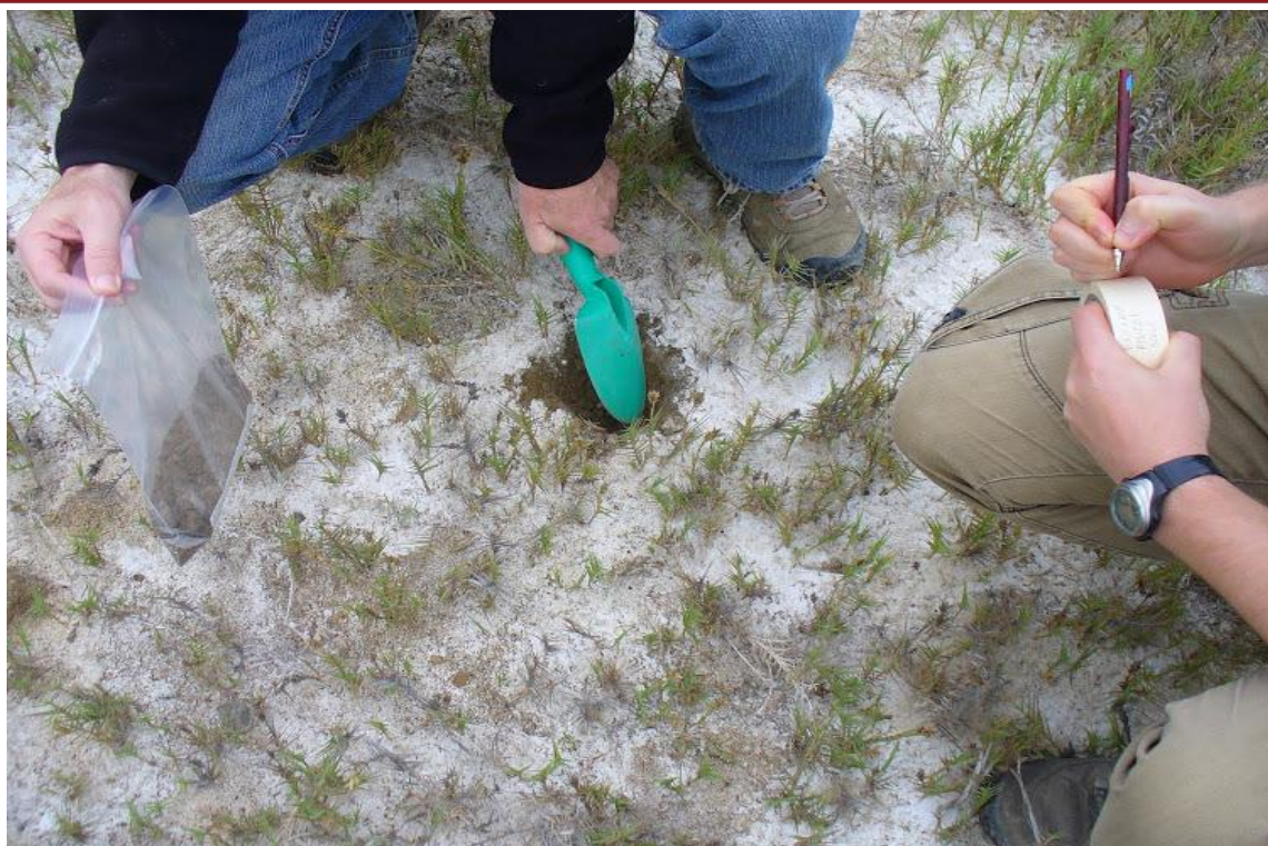
Figura 4. Subsector bajo de áreas de cultivo. Santa Elena, San Pedro de Lloc. Recolección de muestra de suelo en un orificio de 15 cm de profundidad en una bolsa Ziploc, en un área de cultivo de suelo salino con vegetación de grama salada.
