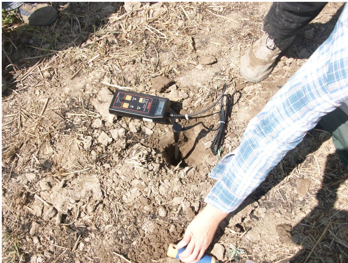
Figura 7. Medición de salinidad in situ con ayuda del conductímetro (Hanna Instruments N° HI 8341) en el subsector alto en San Pedro de Lloc, en una parcela en descanso.
