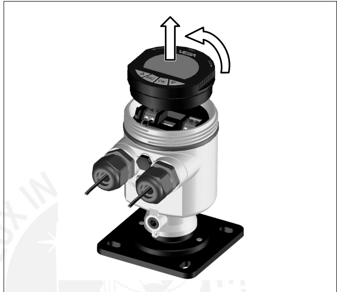
Fig. 6: Desmontaje del módulo de indicación y configuración
