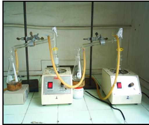
*Figura 2.13 Sistema de destilación simple. Técnica de concentración*
