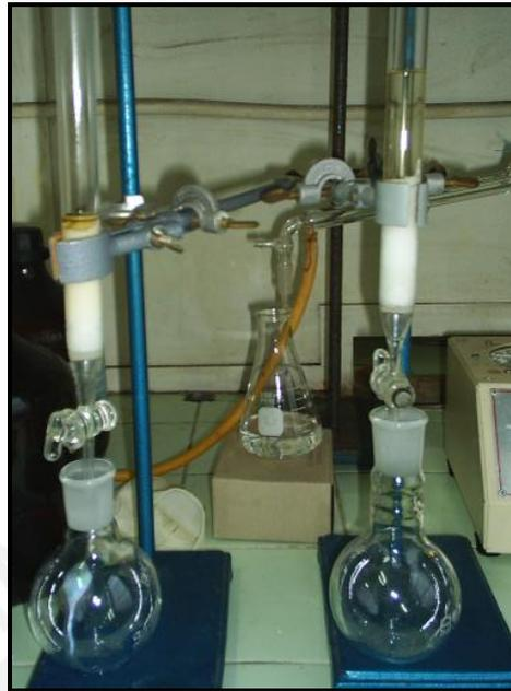
*Figura 2.17 Cromatografía líquida en columna con sílicagel.*
