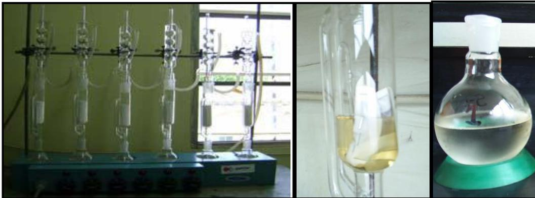
*Figura 2.15 Extracción Soxhlet. Técnica preparativa para muestras de suelos, lodos, sedimentos, tejidos. (Método EPA 3540).*
