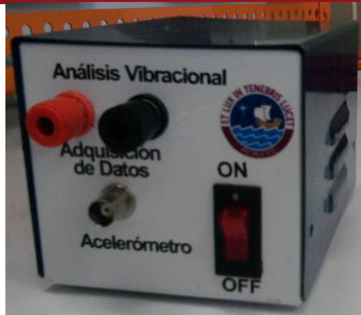
Fig. 4.8 Chasis de fuente de alimentación del Acelerómetro
