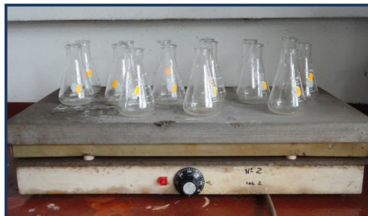
Figura 26. Digestión triácida de muestras en plancha de calentamiento. Fuente propia
