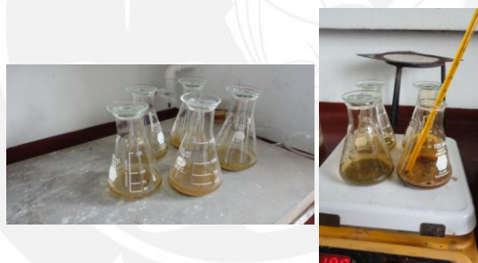
Figura 29. Matraces durante digestión en plancha de calentamiento (izquierda). Matraces en digestión en coccinilla y termómetro para control de temperatura (derecha). Fuente propia
