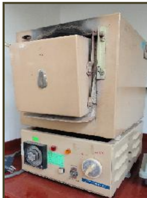
Figura 25. Mufla utilizada para análisis de materia orgánica. Fuente propia
