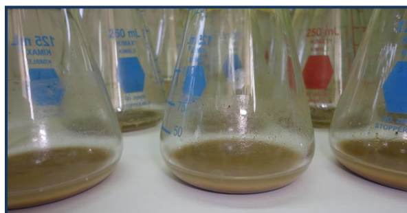
Figura 17. Matracas para digestión de sedimentos por cuadruplicado. Fuente propia
