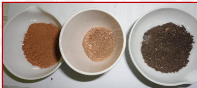
Figura 19. Muestras sometidas a 400°C según Método C. Suelo pabellón V-PUCP (izquierda). Sedimento de laguna (centro). Muestra jardín sección Química-PUCP (derecha). Fuente propia
