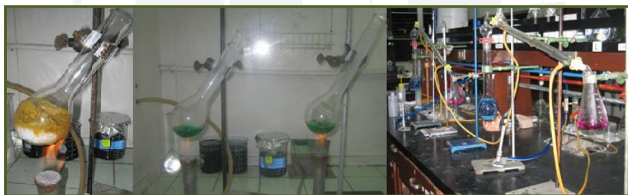
Figura 18. Proceso de digestión y destilación de muestras para N-Kjeldahl por duplicado. Fuente propia
