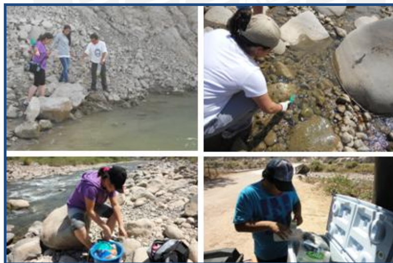
Figura 15. Procedimiento de muestreo. En sentido horario, de superior izquierda: Inspección del área. Toma de muestra. Trasvaso a bolsas ziploc. Almacenamiento, rótulos y medidas in situ. Fotografías del Proyecto DGI PUCP 70245.0110
