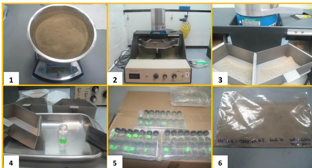
Figura 21. Cuarteo de muestras de sedimento secas. 1. Pesado de muestra desaglomerada en bowl. 2. Máquina cuarteadora o médium riffler rotatorio. 3. Bandejas con muestras durante el cuarteo. 4. Llenado de viales con muestra de cada bandeja. 5. Paquetes de viales obtenidos para diferentes ensayos para cada muestra. 6. Sobrante de muestra guardada como back up. Fuente propia.
