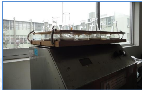
Figura 23. Muestras durante agitación lineal para la determinación de carbonatos. Fuente propia
