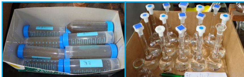
Figura 28. Análisis de Ca, Mg, Na. Tubos de centrifuga de plástico de 50mL con muestras para agitación lineal (izquierda). Estándares y diluciones de muestras para su determinación por AAS. Fuente propia
