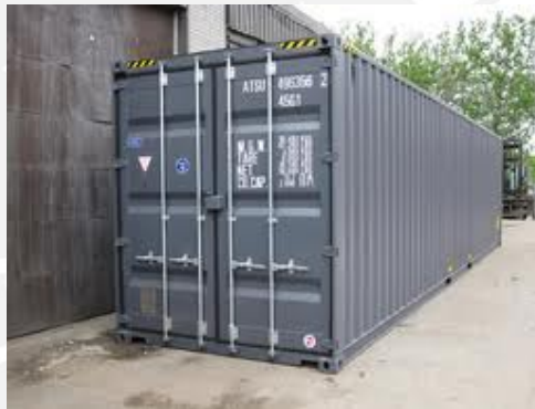
Gráfico 6 – Contenedor High Cube Fuente: Muelle Centro
