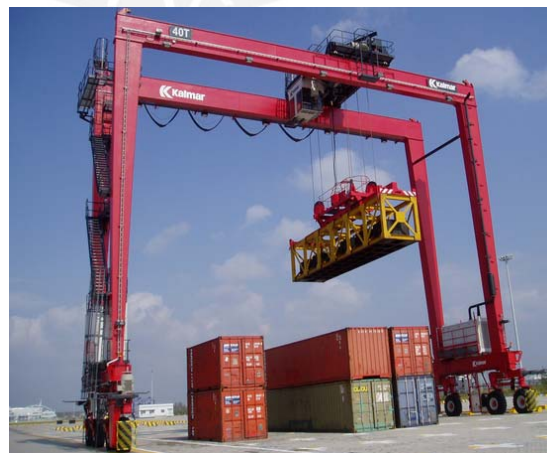
Gráfico 15 – Grúa RTG Fuente: Muelle Centro
