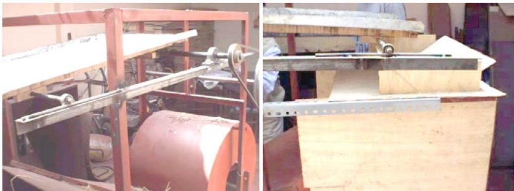
Figuras 3.13 y 3.14: Vista general de la bandeja y detalle del eje inferior. Obsérvese la inclinación dada a las dos vigas de apoyo.
