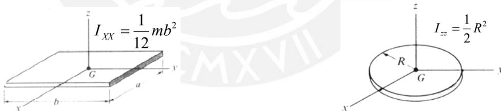
Figuras 3.34 y 3.35: Inercias de una placa delgada y un disco circular plano, respectivamente.
