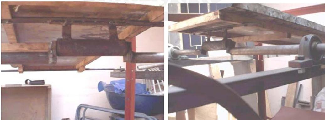
Figuras 3.18 y 3.19: detalle de la biela-manivela
