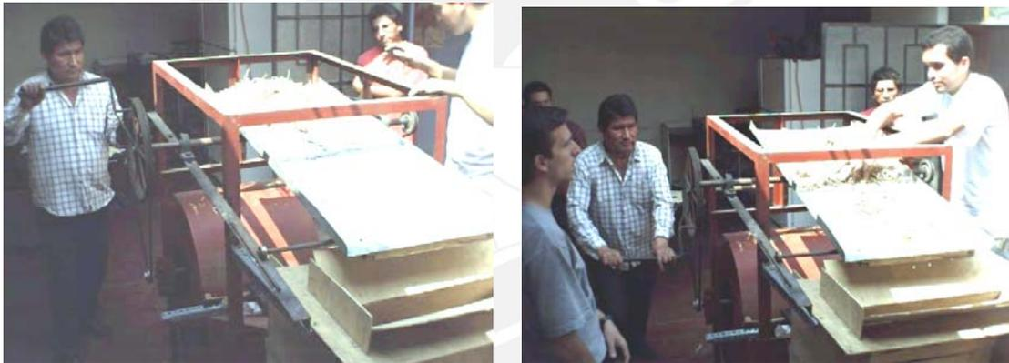
Figuras 3.39 y 3.40: pruebas finales con mezclas de trigo y broza. Se observa el embudo colocado sobre el ducto.
