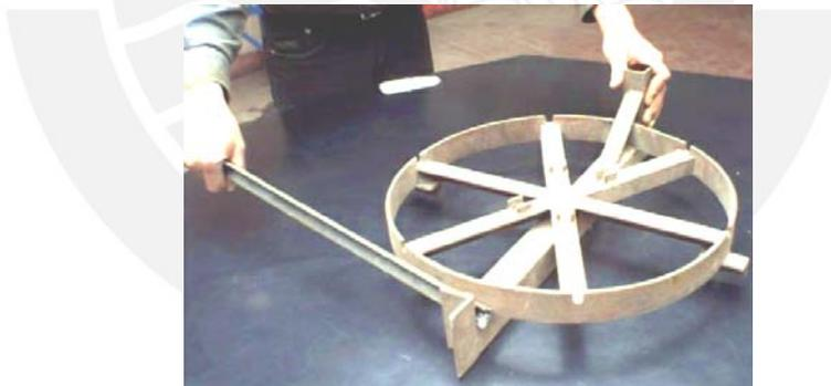
Figura 3.22: matriz para fabricar la rueda de la polea.
