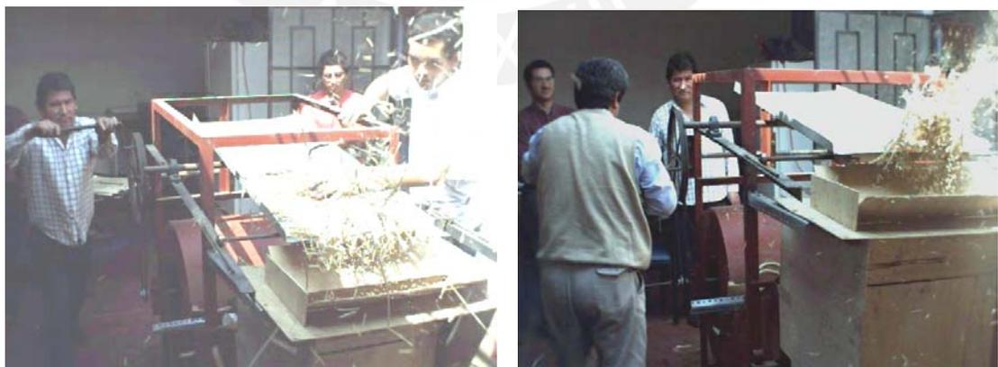
Figuras 3.41 y 3.42: Pruebas finales con mezclas de trigo y broza.
