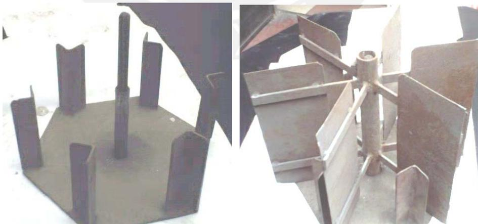
Figuras 3.5 y 3.6: Matriz utilizada en la fabricación del rotor.
