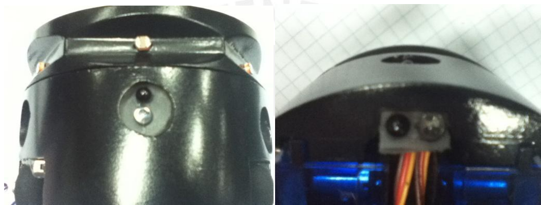
a) Sensores de Obstáculos b) Sensores de Piso Figura 3-5 Sistema de Sensado de Obstáculos
