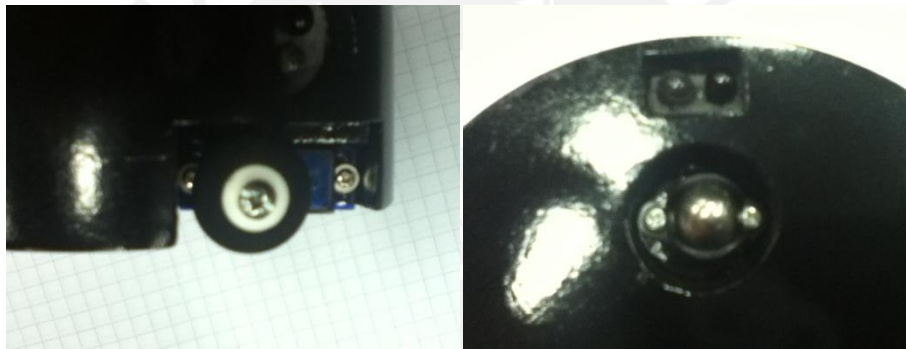
a) Vista Perfil Servomotores b) Vista Inferior Rueda Pivote Figura 3-3 Sistema de Desplazamiento Detallado
