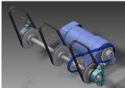
Figura 3-25: Sistema de distribución de potencia en máquina ordenadora
