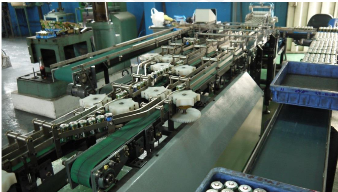
Figura 5-12: Vista del ingreso de pilas y su salida a través de la faja auxiliar 3
