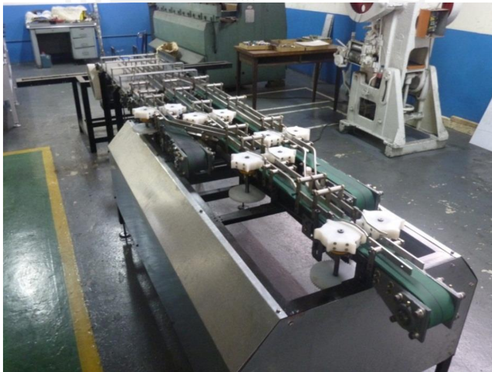
Figura 5-6: Primeras máquinas terminadas y en preparación para las pruebas con pilas.
