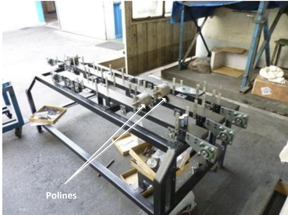
Figura 5-3: Montaje de polines motrices, de retorno y de cabeza en máquina ordenadora
