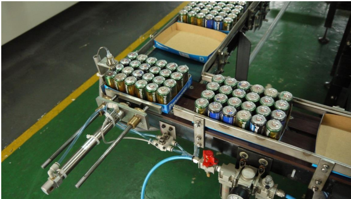
Figura 5-9: Mecanismo de salida de bandejas llenas.
