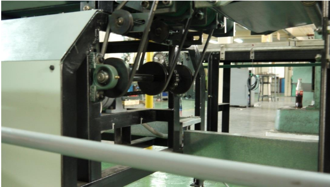
Figura 5-11: Distribuidor de potencia en máquina ordenadora, nótense el detalle de las poleas tensoras.
