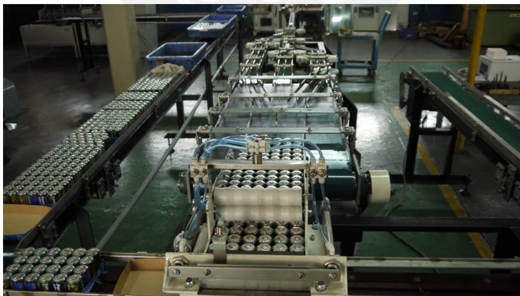
Figura 5-8: Conjunto de fajas auxiliares acopladas a máquinas centrales, pruebas con pilas.
