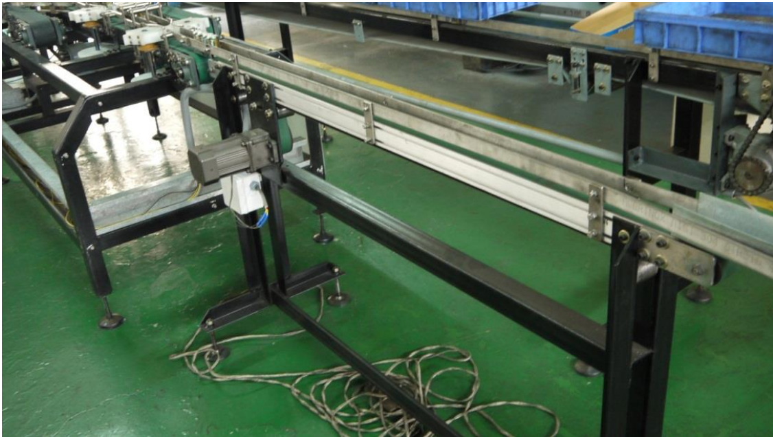
Figura 5-13: Faja auxiliar 1, ingreso de pilas desde la línea de producción
