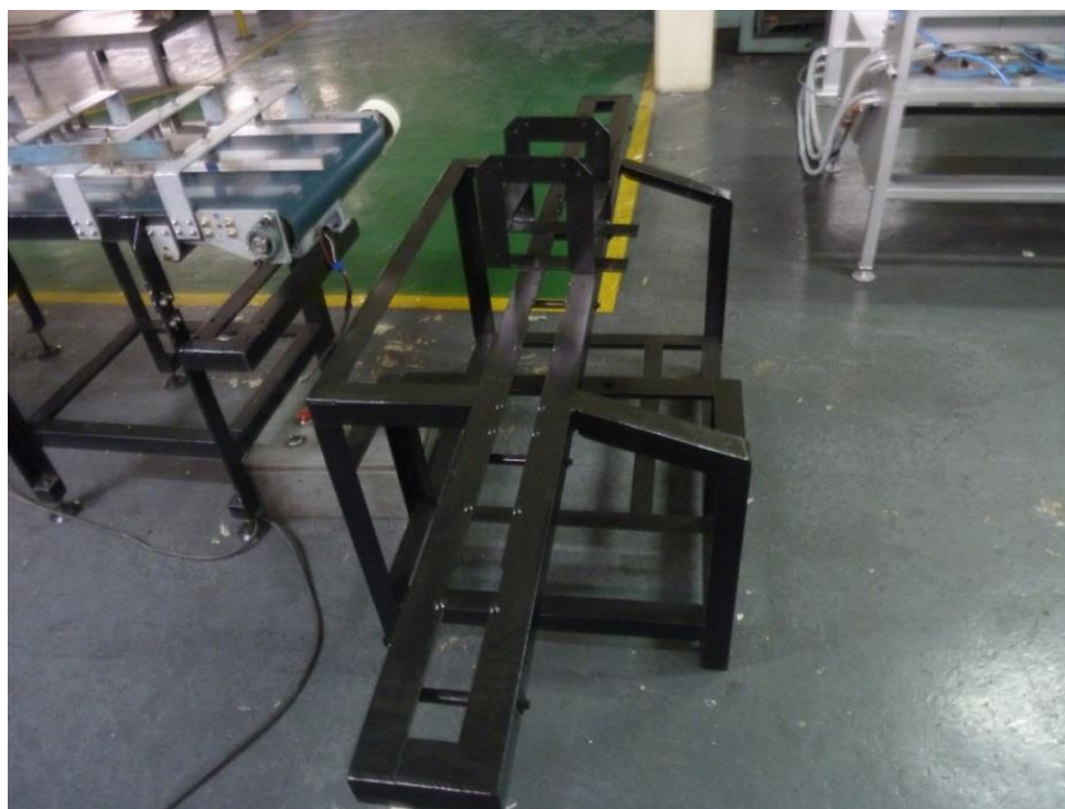
Figura 5-7: Estructura de llenadora lista para ensamblaje.
