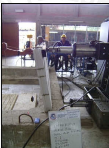
Figura 7.1. Ensayo estático de murete M1
