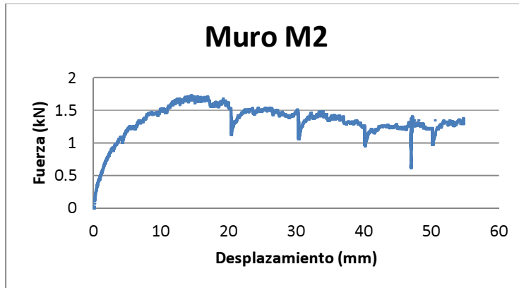
Figura 7.6. Gráfica de ensayo estático Fuerza vs Desplazamiento Murete M2
