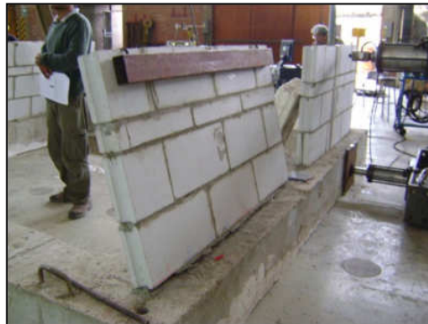
Figura 7.4. Ensayo estático de murete M4
