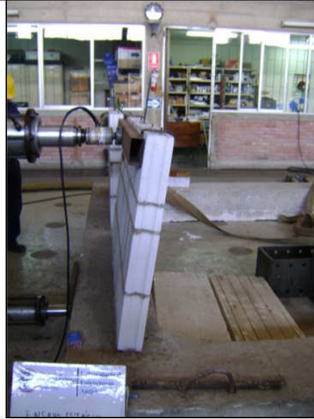
Figura 7.2. Ensayo estático de murete M2
