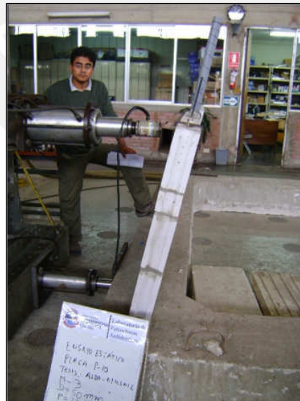
Figura 7.3. Ensayo estático de murete M3
