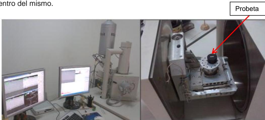
Figura 26. Microscopio electrónico.
