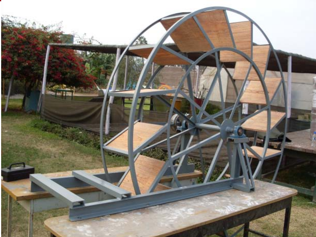
Figura 3.8: Rueda Prototipo para ensayo: 2 m diámetro exterior
