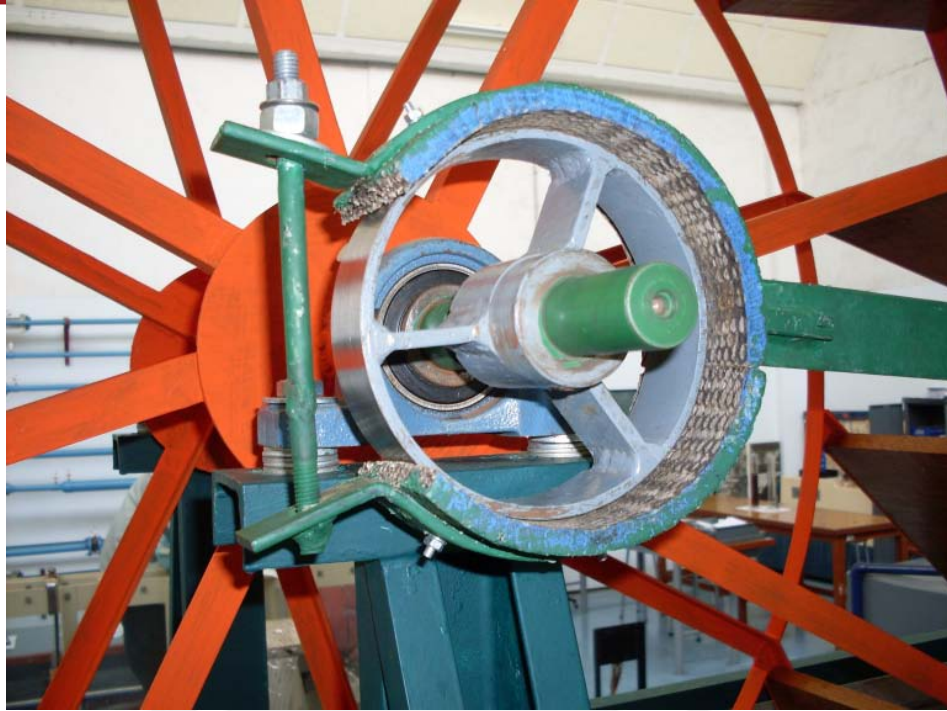
Figura 3.15: Freno – Sistema de ajuste
