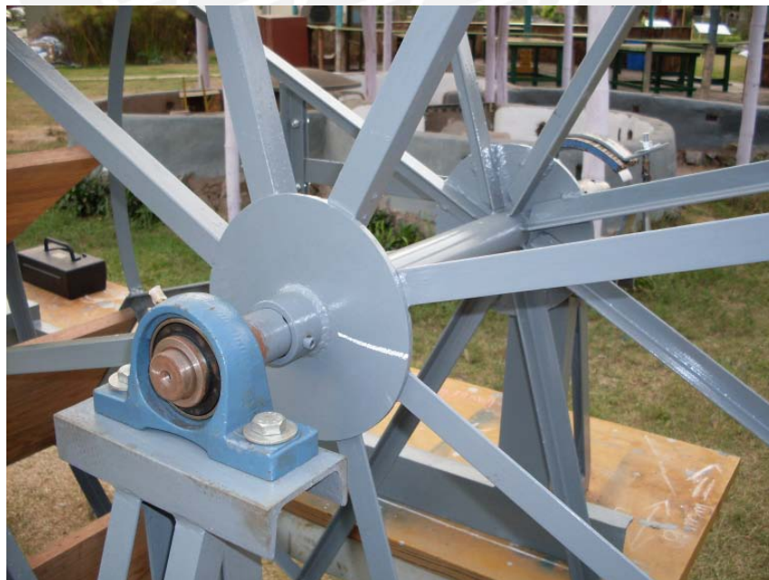
Figura 3.10: Detalle unión Armadura – Eje – Chumacera
