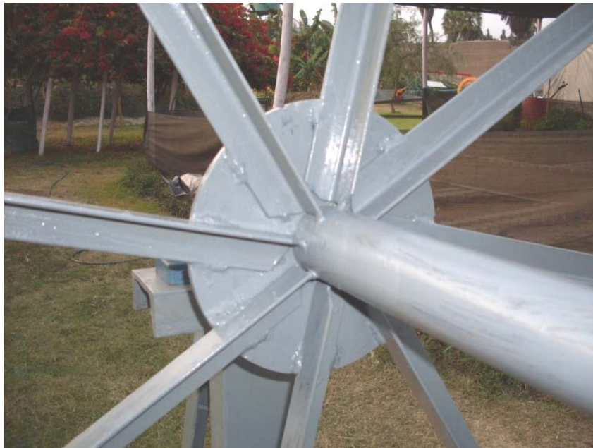
Figura 3.9: Detalle unión Radios – Disco - Tubo
