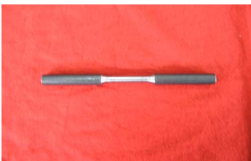
Figura 5. Probeta redonda para ensayo
