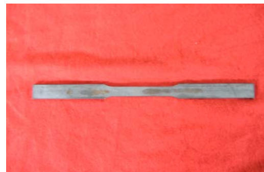
Figura 6. Probeta plana para ensayo
