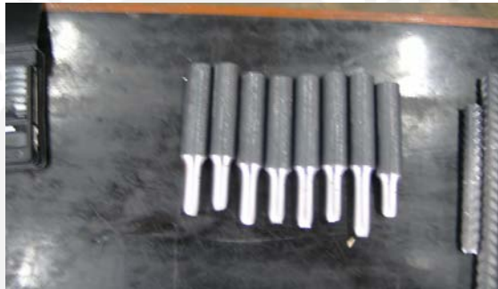
Figura 9. Probeta redonda después del ensayo
