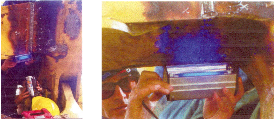
Figura 9: Fotografías relacionadas a la inspección por partículas magnéticas. Se requirieron ensayos de partículas magnéticas y ultrasonido (Informe de inspección entregado a la minera por el servicio de la inspección particular contratado).
