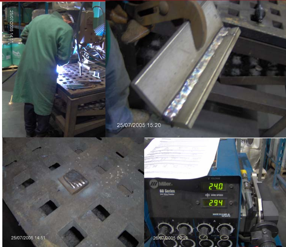
Figura 12: Pruebas de metal depositado y de soldabilidad realizadas en USA a los lotes de alambre fabricados para el proyecto.
