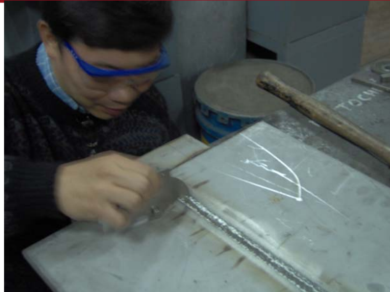
Figura 14: Calificación de procedimiento de soldadura en posición 3G y de acuerdo a ASME Sección IX.
