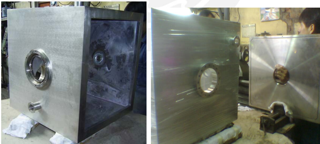
Fig. 4.3: Izquierda: ventana sobre una de las caras de la cámara para observar el proceso, así como el marco donde se ubica el o-ring para el sello con la puerta. Derecha: puerta con canal para el o-ring y la ubicación de la ventana sobre la puerta de la cámara.
