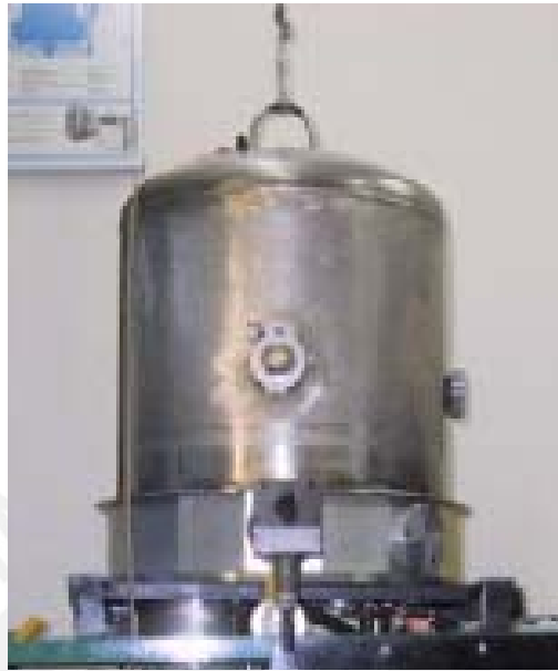
Fig. 3.1: Forma clásica de destapar una cámara de vacío
