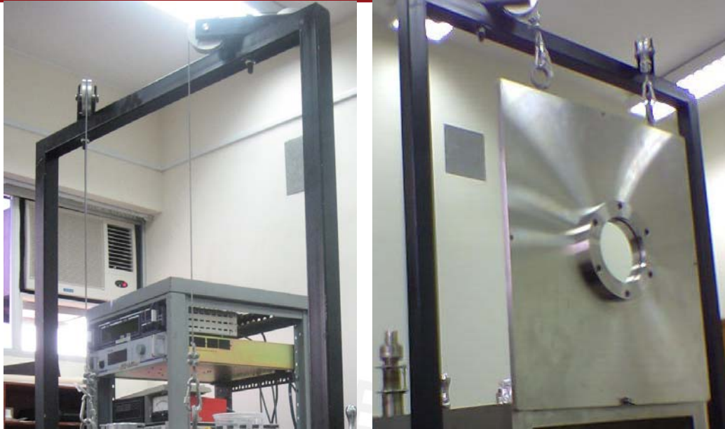
Fig. 4.18: Mecanismo de izaje para la puerta de la cámara de vacío.
