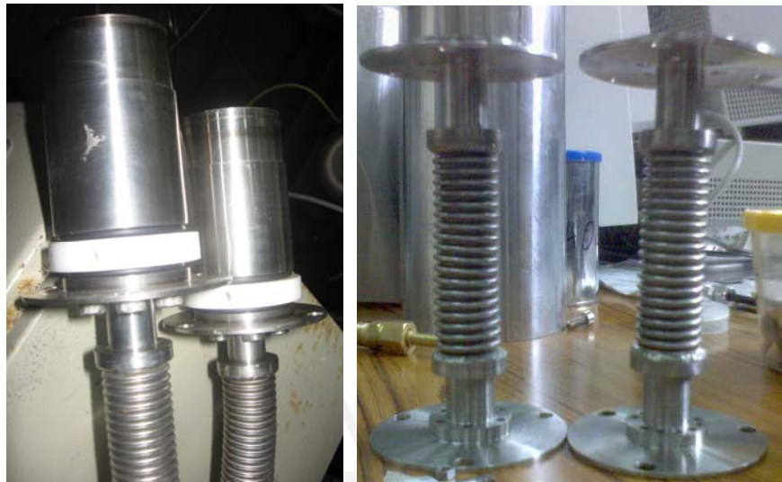
Fig. 4.14: Izquierda: magnetrón ensamblado. Derecha: elementos flexibles que permiten el movimiento al magnetrón
