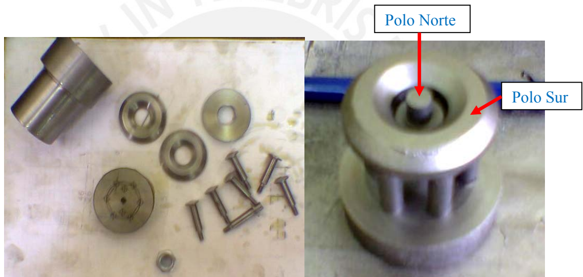
Fig. 4.10: Estructura que genera el campo magnético
