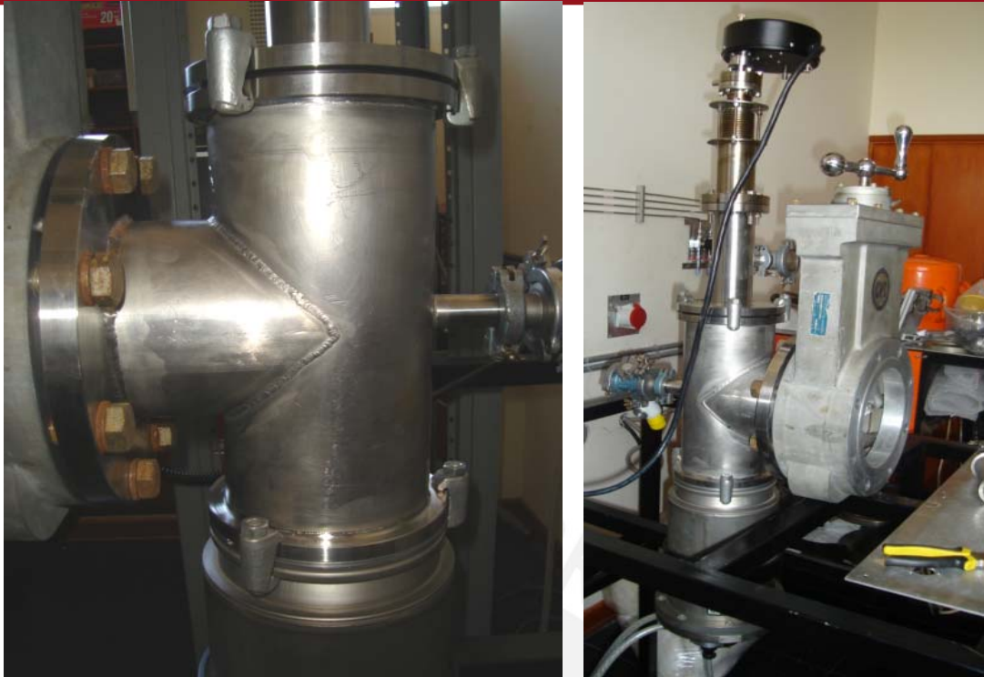
Fig. 4.21: Izquierda: Conector en cruz. Derecha: Conector en cruz con bomba turbomolecular, espectrómetro de masas, sensor de presión y compuerta
