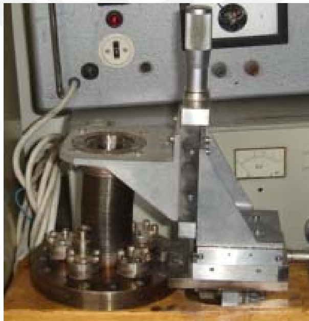
Fig. 4.4: Posicionador de muestras disponible en el laboratorio
