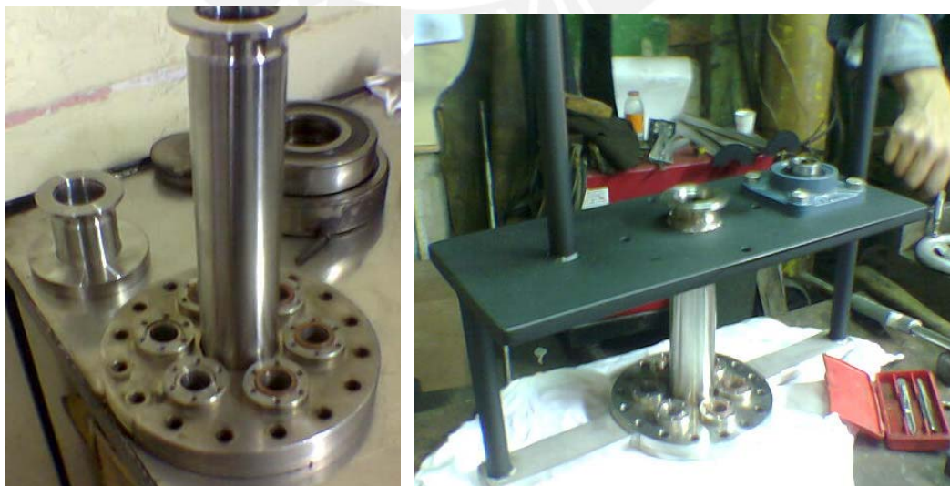
Fig. 4.5: Estructura del manipulador
