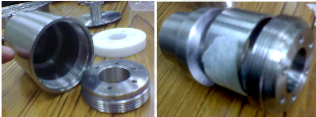
Fig. 4.15: Izquierda: casco, anillo de ajuste y anillo de aislamiento en teflón. Derecha: porta imanes, anillo separador y anillo de ajuste en el orden que ingresan al casco
