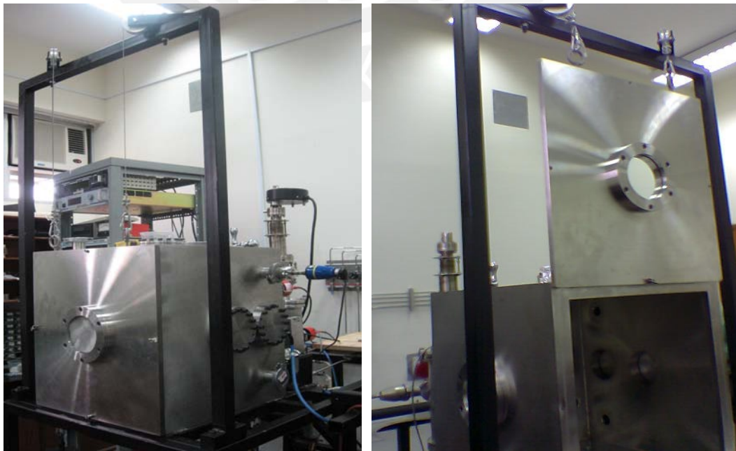
Fig. 4.22: Instalación de la cámara y mecanismo de izaje de la puerta
