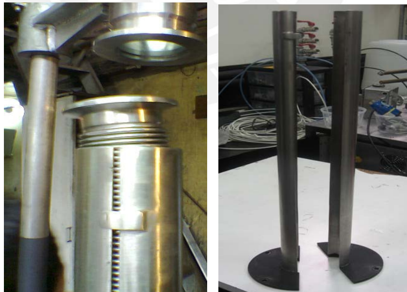
Fig. 4.7: Izquierda: tubo flexible con su guía, Derecha: guía del tubo flexible.
