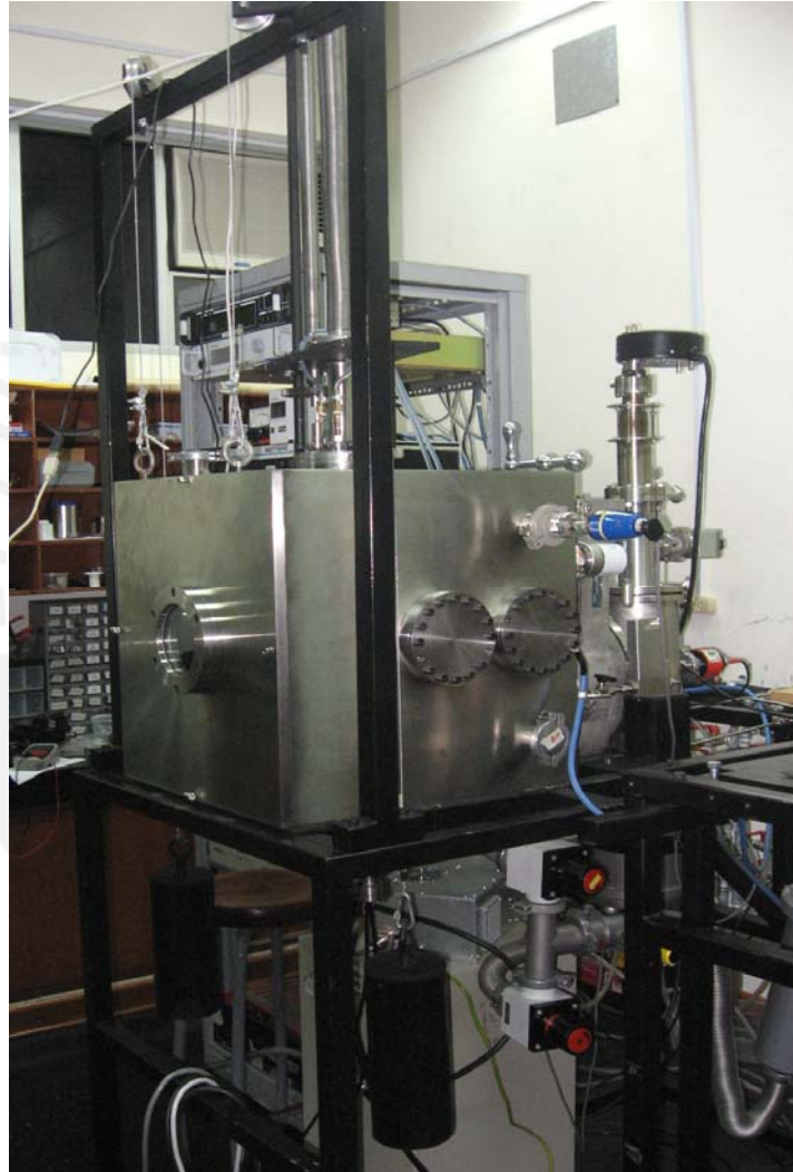
Fig. 4.25: Equipo de magnetron sputtering en alto vacío instalado en el Laboratorio de Ciencia de los Materiales, en la Sección de Física de la Pontificia Universidad Católica del Perú
