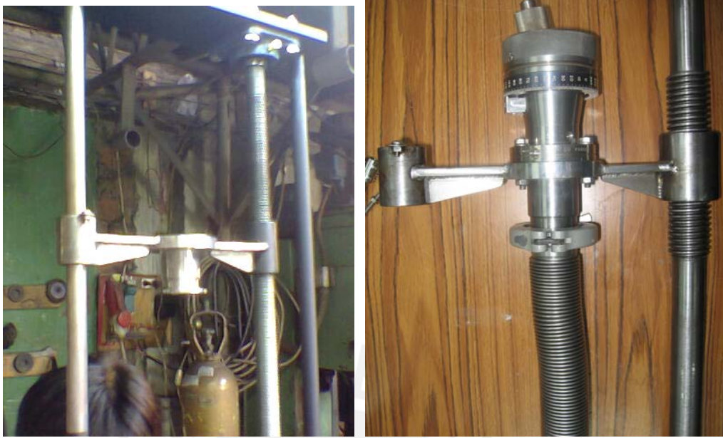
Fig. 4.6: Izquierda: conector de desplazamiento. Derecha: conector de desplazamiento ensamblado con la manguera y el sujetador de la muestra
