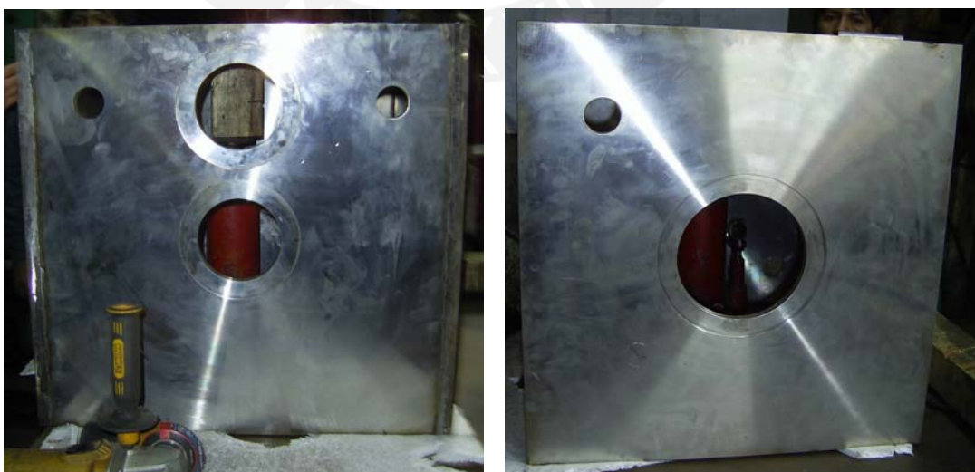
Fig. 4.1: Mecanizado de la cara izquierda y de la cara superior respectivamente
