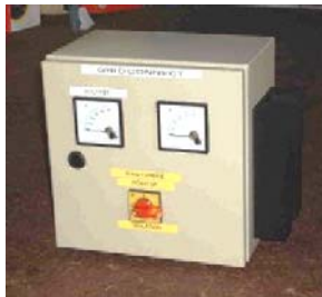
Figura 4.6 Controlador y Rectificador con Amperímetro y Voltímetro del Aerogenerador Proven
